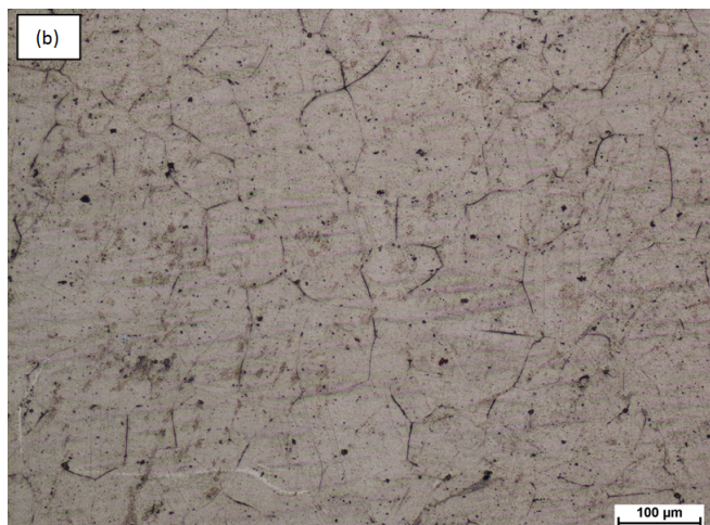
FIGURE 4.7: Microstructure obtenu à partir du microscope optique de l'échantillon traité à 800°C pendant : (a) 8h, (b) 24h
