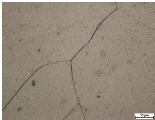
FIGURE 4.8: Précipitation de sigma au niveau des joints de grains
