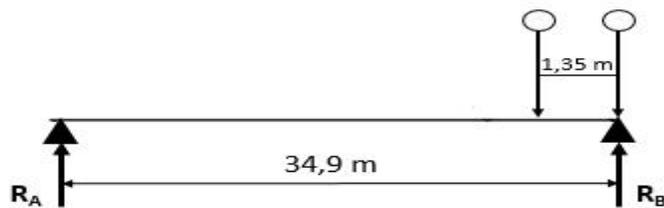
Figure IV.26: Poutre sous la surcharge Bt à (x=0L).
