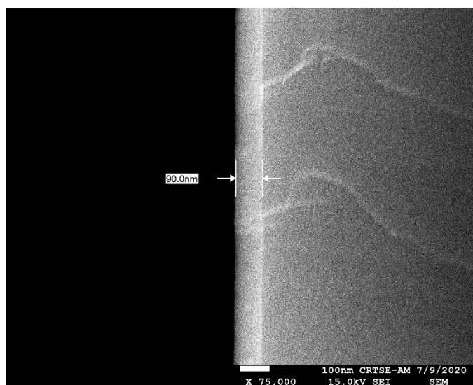
Figure 3. 3 : Imagerie MEB en vue transversale de la CAR \text{SiO}_2\text{-SiC} réalisée sur du Si plat pour un temps de dépôt de 15 minutes.
