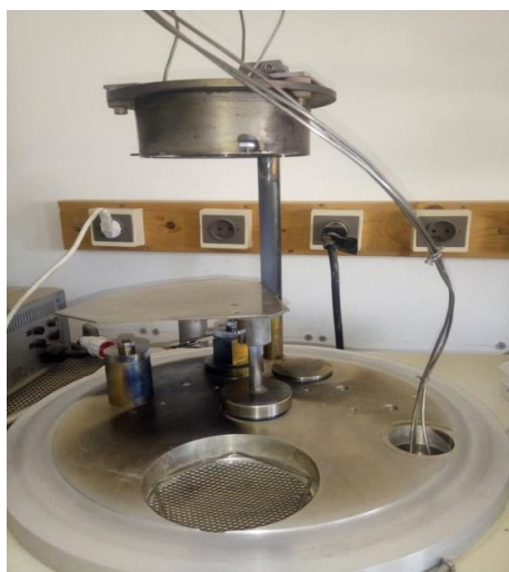
Figure 2. 5 : Dispositif d'évaporation sous vide (CRTSE).
