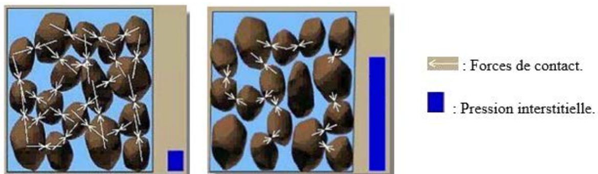
Figure 1 - 1 : Phénomène de la liquéfaction à l'échelle microscopique
