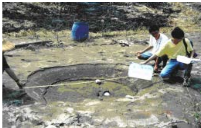
Figure 1 - 12 : Ebullitions de sable de Zhanghua en Taiwan.
