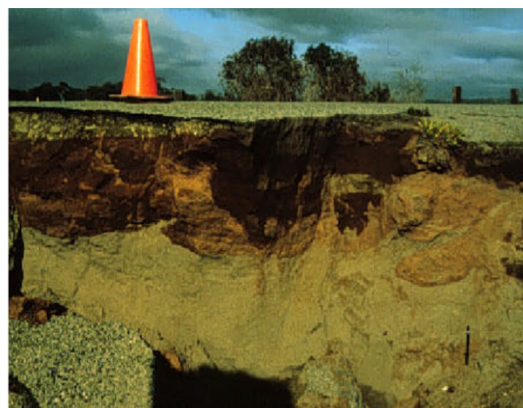
(b) Section transversale des couche sols sous-jacents
