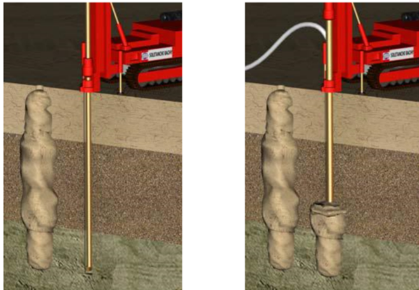
FIGURE 3.10: Amélioration de sol par injection solide.
