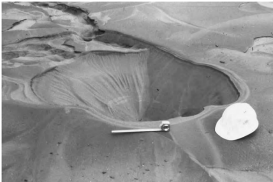
FIGURE 1.9: Ébullition du sable induite par la liquéfaction après le séisme de la Loma Prieta de 1989, Californie.[1]
