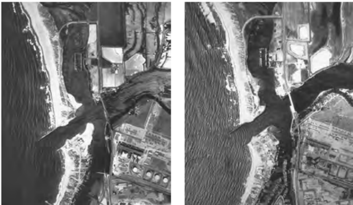
FIGURE 1.10: Photos aériennes de Moss Landing, en Californie, montrant le cadre géologique ; La photo de gauche est de 1952 et la photo de droite est de 1987. En comparaison, ces photos peuvent identifier les mouvements du littoral, les charges artificielles et la construction récente (photos : USGS).[1]
