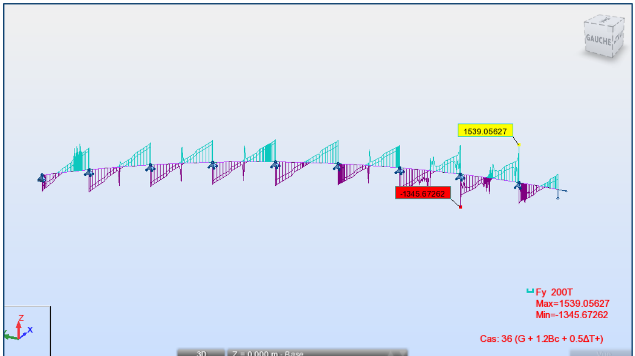
Figure.5.18. Diagramme de l'effort tranchant sous G + 1.2Bc + 0.5\Delta T
