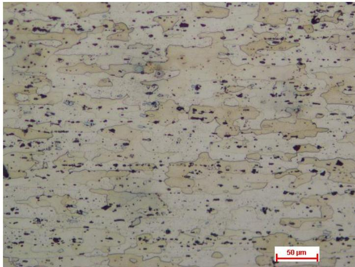
Figure 5-17 La microstructure de l'échantillon e=4mm avec G×200
