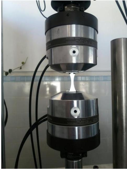
Figure 4-9 éprouvette placée sur la machine.
