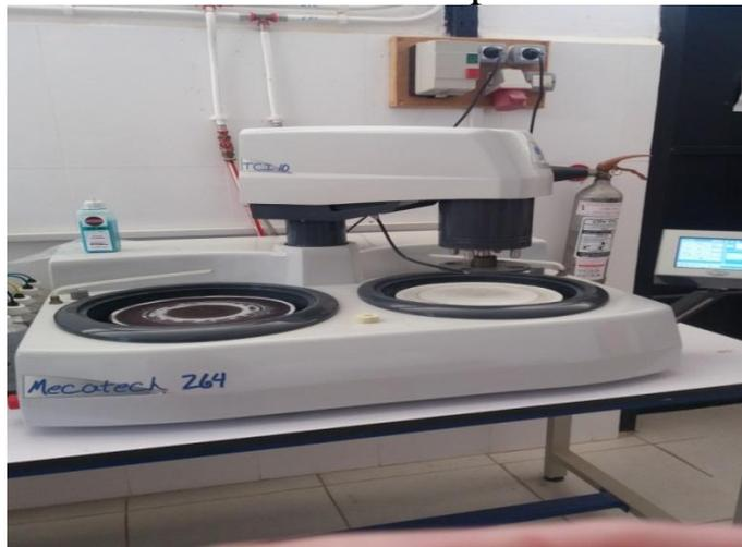
Figure 4-14 Polisseuse automatique du CRTI.
