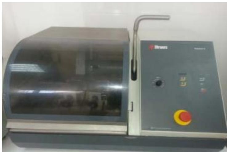
Figure 4-11 micro tronçonneuse utilisée au CRTI.
