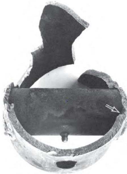
Figure 1-21 Surface d'une rupture fragile dans un acier 1035 étiré à froid et détendu, la fracture provient d'un défaut de soudure (flèche) pendant les tests [13].
