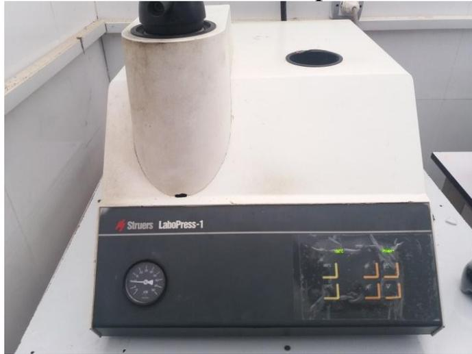
Figure 4-12 Enrobeuse à chaud du CRTI.
