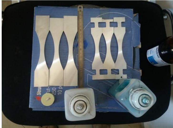
Figure 4-2 Les éprouvettes après la préparation.
