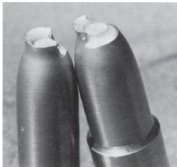
Figure 1-18 Fracture oblique d'une éprouvette en traction d'un acier inoxydable de type 302 [14].
