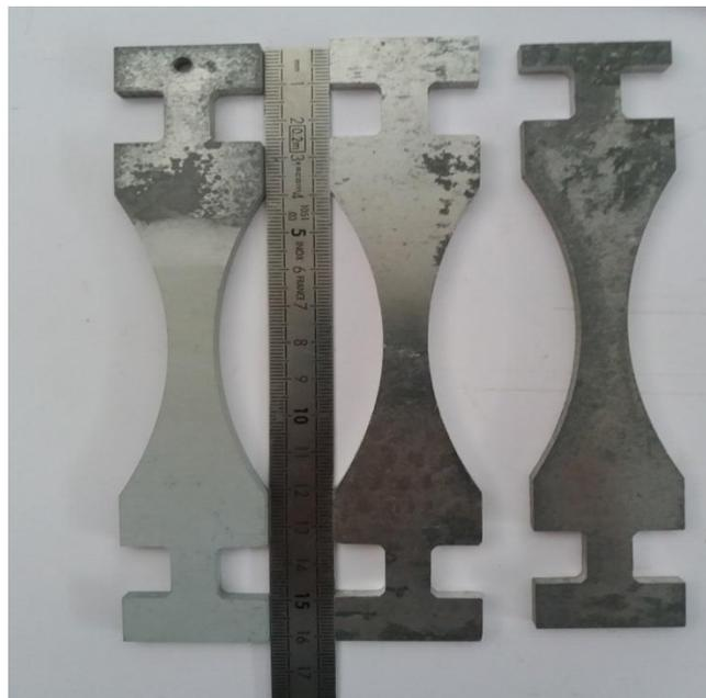
Figure 4-1 Les éprouvettes avant la préparation.
