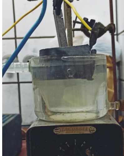
Figure IV.8 : Le renforcement par voie électrolytique dans une solution (acides sulfurique+SiO 2 ).
