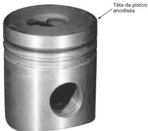
Figure III.10 : Tête de piston traitée par anodisation dure [10]
