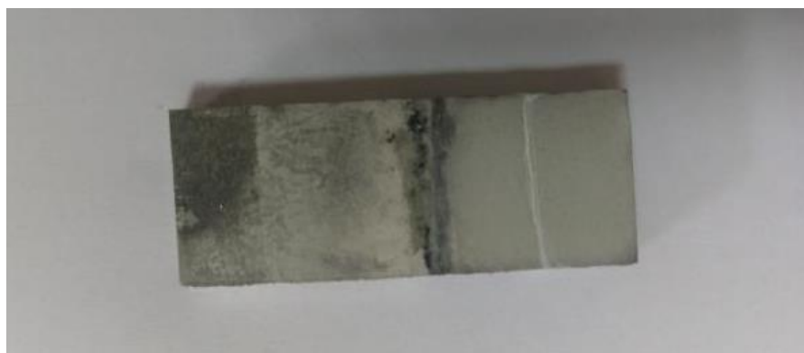
Figure V.10 : l'échantillon après renforcement électrolytique avec les nanoadditifs.
