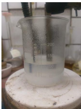
Figure IV.7 : Le renforcement par voie chimique (colmatage avec l'eau bouillon+nanoadditif).
