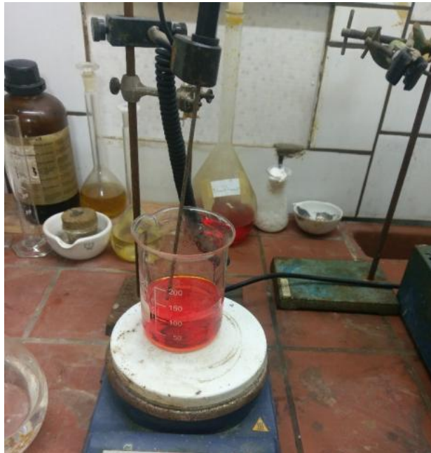
Figure IV.4 : Le blanchement dans un mélange acide sulfurique / acide chromique.
