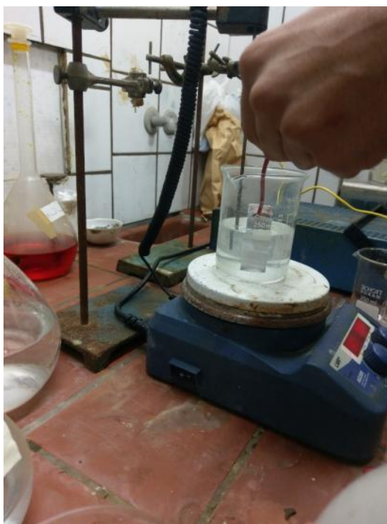
Figure IV.3 : Le décapage dans une solution alcaline (NaOH).
