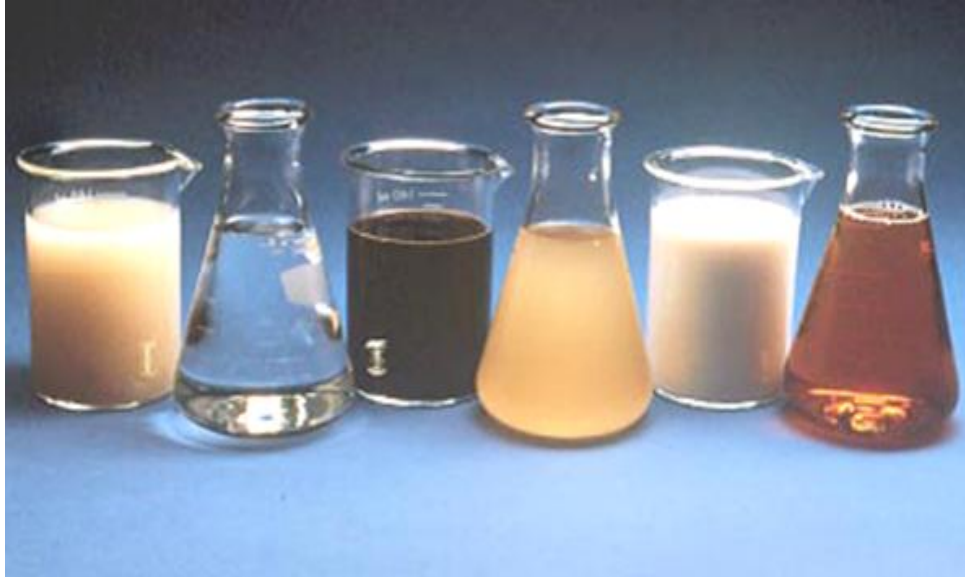
Figure 1.3: Adjuvants liquides de gauche à droite : agent anti-lessivage, réducteur de retrait, réducteur d'eau, agent moussant, inhibiteur de corrosion et agent entraîneur d'air. (6)
