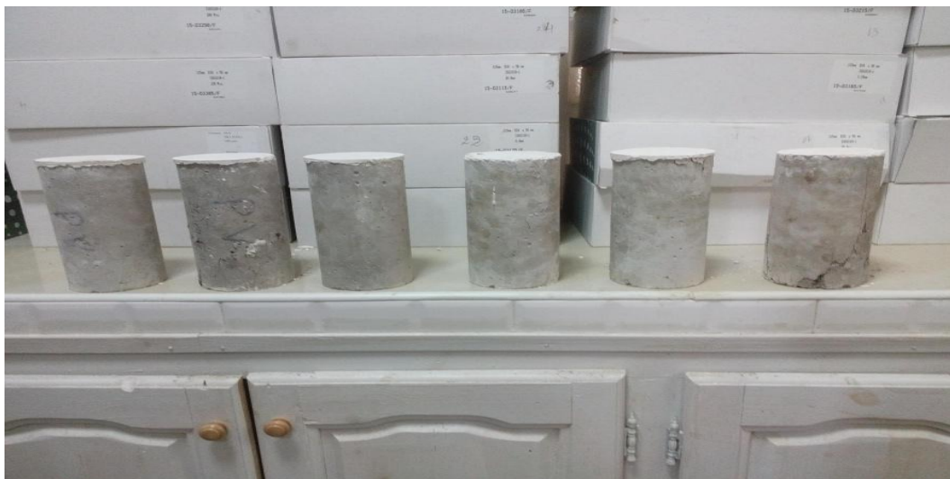
Figure 4.12: Les Eprouvettes cylindriques après l'essai de compression
