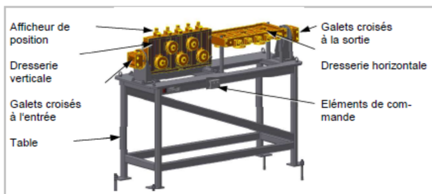
Figure VI.11. Structure du dispositif de dressage.
