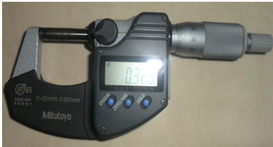
Figure VI.3. Palmer utilisé pour la mesure du diamètre.
