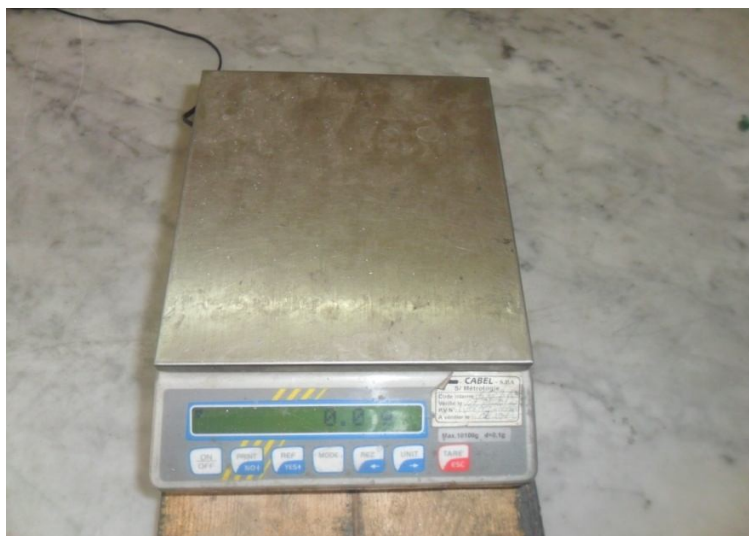
Figure VI.4. Balance pour le calcul de la masse métrique.
