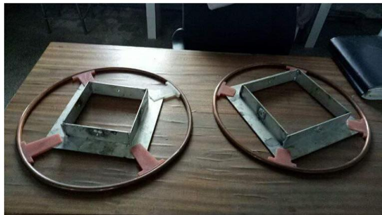
Fig. VI.10: montage des cadres sur les cerceaux.
