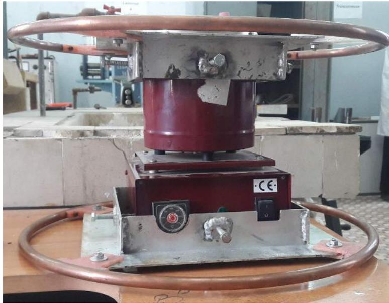
Fig.VI.12: fixation du four sur le dispositif fabriqué.
