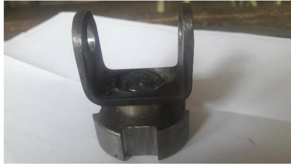
Fig.VI.38: soudage de la pièce avec le joint de cardon.
