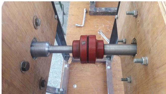
Fig.VI.50: montage des axes et de l'accouplement.
