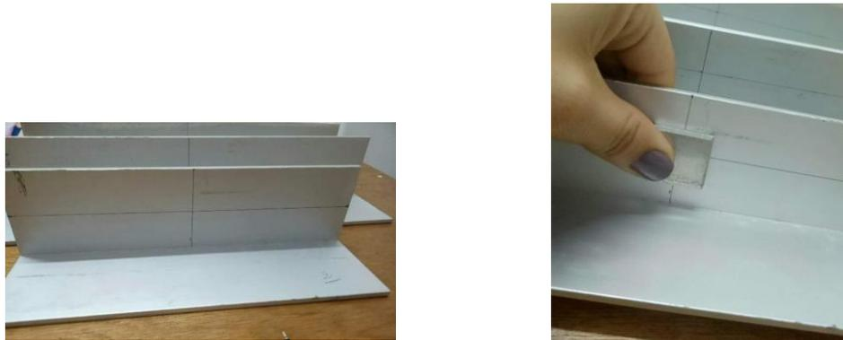
Fig.VI.4 : augmentation de l'épaisseur des cornières par de petites pièces carrées en aluminium.
