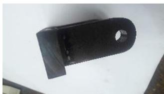
Fig.VI.23: perçage des supports des galets.
