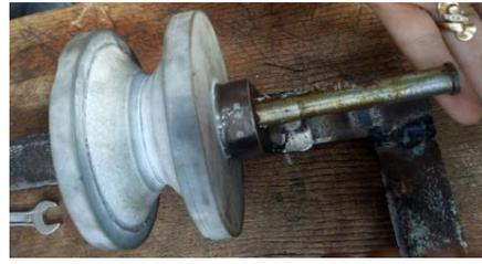
Fig.VI.25: fixation des galets dans leurs supports par les arbres usinés et circlips.
