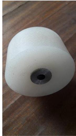
Fig.VI.19 : coulage de la résine pour la fabrication des galets.
