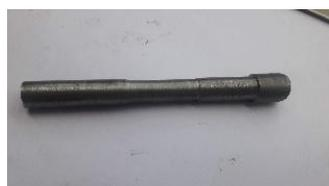
Fig.VI.24: arbre de fixation des galets.
