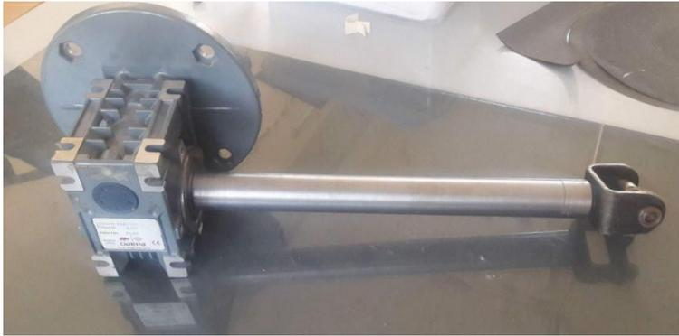
Fig. VI.43: fixation de l'axe dans le réducteur et joint de cardon.
