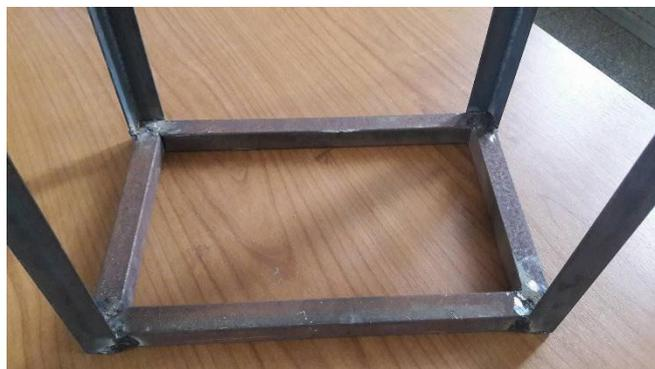
Fig.VI.30: assemblage et soudage des cornières sur le cadre.
