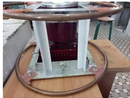
Fig.VI.15: maintien de la distance entre les cerceaux.
