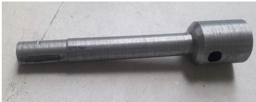
Fig.VI.48: axe liant l'accouplement au moteur.
