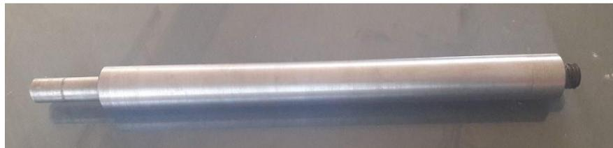
Fig.VI.42: l'axe de transmission de mouvement.
