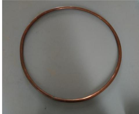
Fig.VI.1: un cerceau en tube de cuivre, cintré et brasé.
