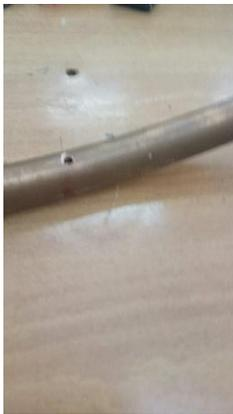
Nous avons percé les cerceaux avec un foret de diamètre de 3mm, puis nous avons taraudé les trous avec un taraud de diamètre de 4mm (Fig. VI.7).
