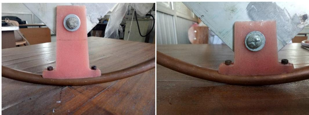
Fig.VI.11: fixation des cadres en aluminium sur les pièces en résine.
