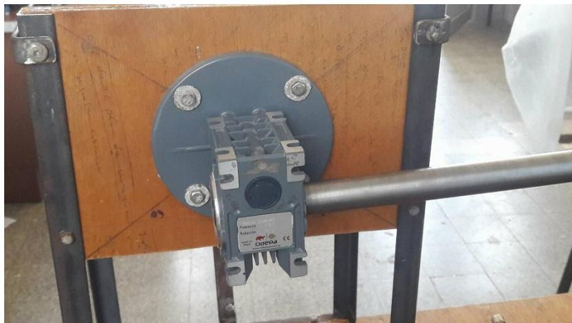
Fig. VI.44: fixation du réducteur sur la structure porteuse.
