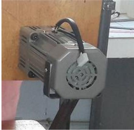
Fig.VI.49: fixation du moteur sur la structure porteuse.
