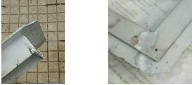
Fig. VI.6: découpage et limage des coins des cadres.
