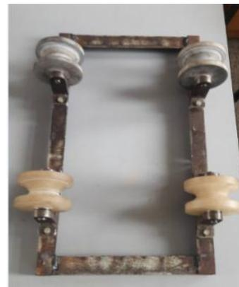
Fig.VI.27: emplacement des galets sur le support.
