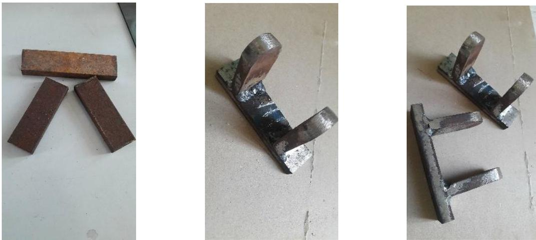
Fig.VI.22: l'assemblage et le soudage des petits profilés.
