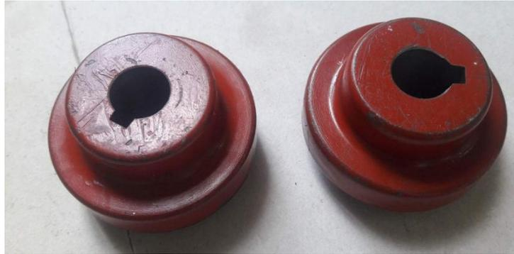
Fig.VI.46: usinage de l'accouplement.
