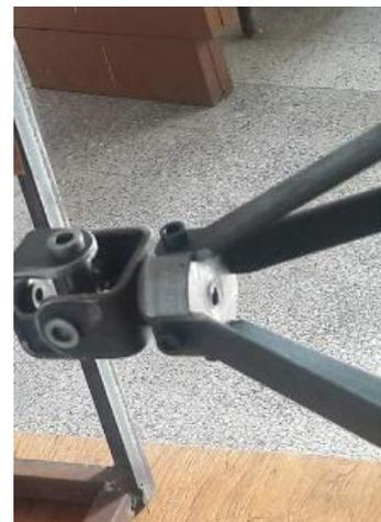
Fig.VI.40: fixation des fers plats avec la pièce.
