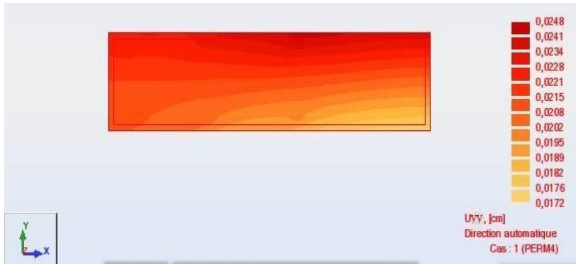
Figure III-13 : Déformation horizontale U_{yy} du plan du massif
