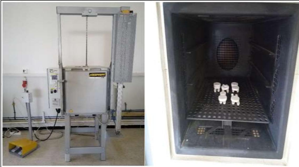
*Figure V.14 : Four du déliantage et la disposition des pastilles dans le four.*
