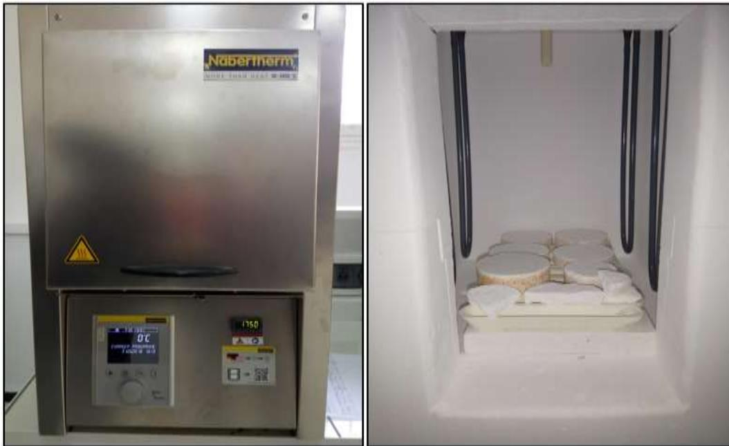
Figure V.15 : Four de frittage, dispositions des pièces dans le four.
