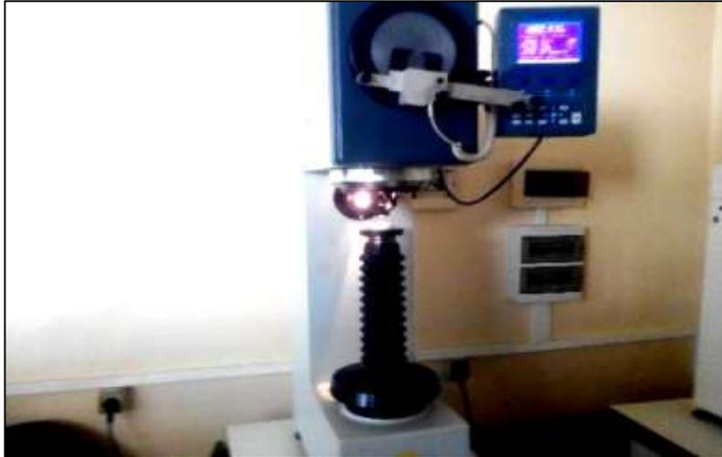
Figure VI.5 : Duromètre utilisé de type INNOVATEST Testwell.
