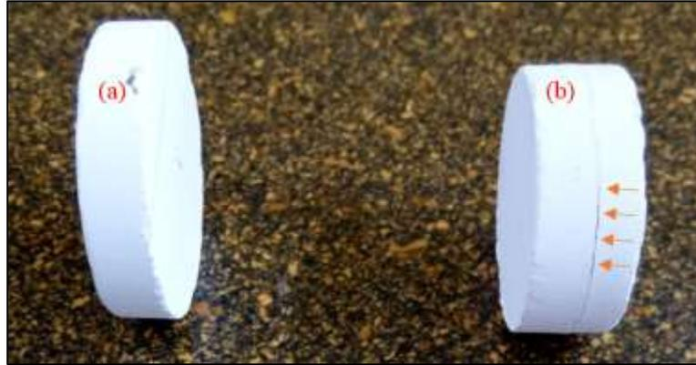
Figure V.19 : Echantillon fritté (a) poudre de 10 $\mu$ m, (b) poudre nanométrique.
