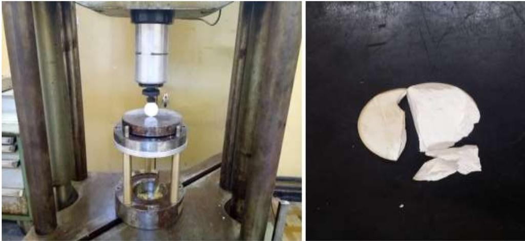
Figure VI.8 : Essai brésilien appliqué pour l'échantillon dopé par MgO de  $\Phi 40\text{mm}$  de diamètre et de 15mm d'épaisseur.
