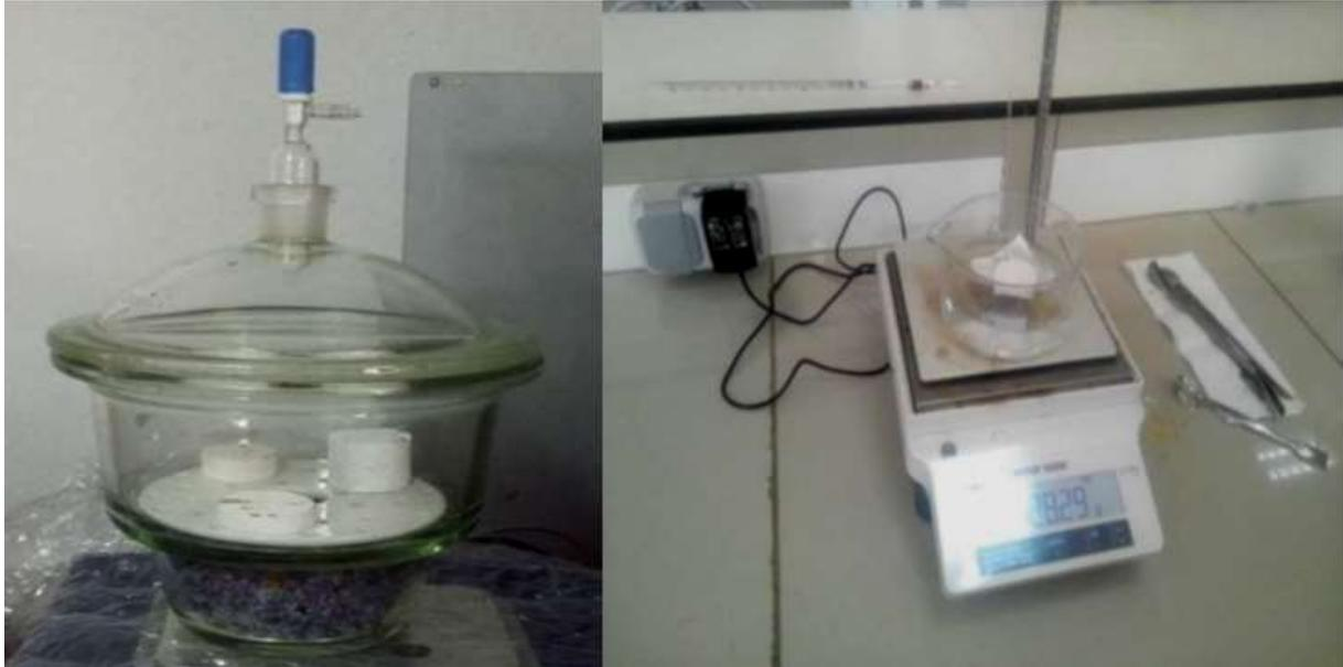
Figure VI.3 : Echantillons dans un dessiccateur contenant du Silica gel, dispositif de mesure.
