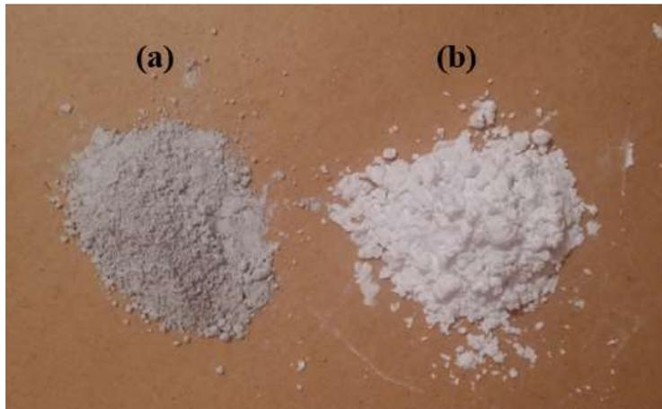
Figure IV.15 : Poudre broyée au : (a) broyeur planétaire, (b) broyeur a tambour.
