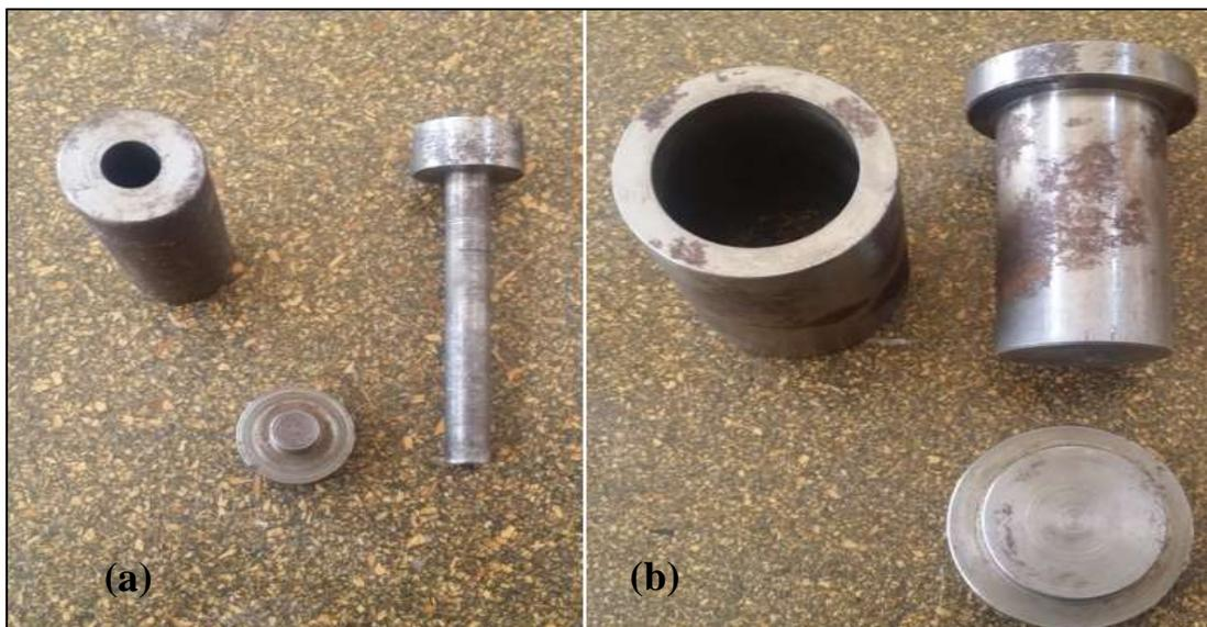
Figure V.2 : Moule des pastilles (a) compression  $\Phi 8\text{mm}$ , (b) densité, dureté et essai brésilien  $\Phi 40\text{mm}$ .
