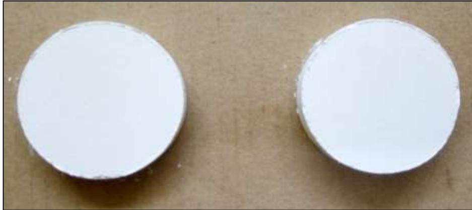
Figure V.12 : pastilles pressées sous 140, 160MPa.
