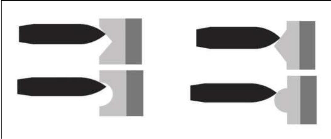
Figure III.5 : Vue de coupe des configurations étudiées pour objectif d'analyser la trajectoire du projectile : surface cible pyramidale convexe B, pyramidale concave C, hémisphérique convexe D, hémisphérique concave E [10].
