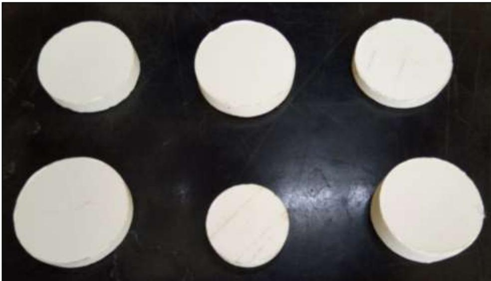
Figure V.18 : Pastilles à la sortie du four de frittage.
