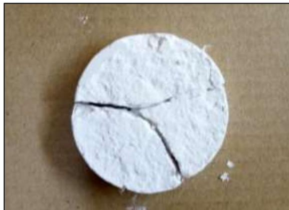
Figure V.11 : Pastille pressée sous 180MPa.
