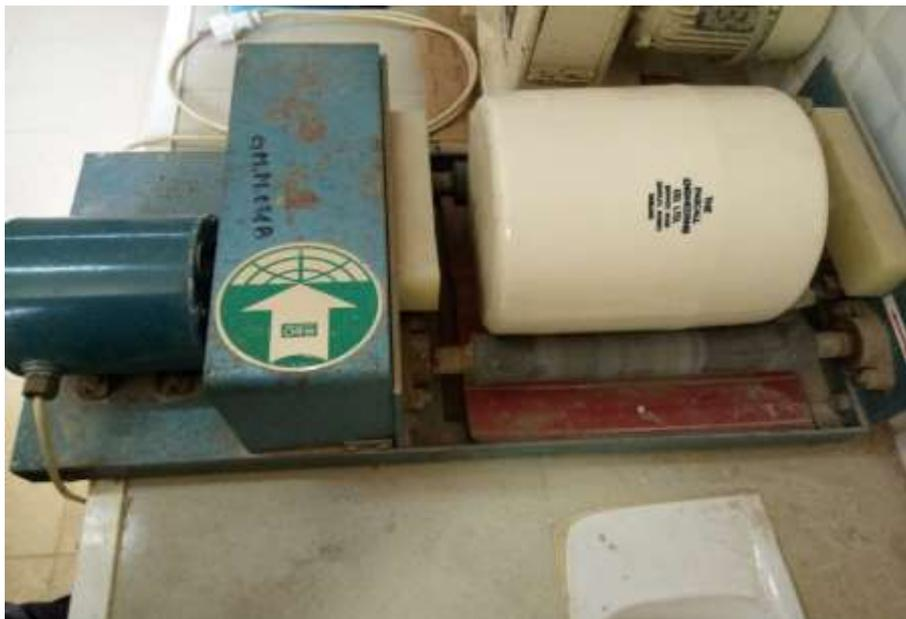
*Figure IV.8 : Broyeur à tambour utilisé.*
