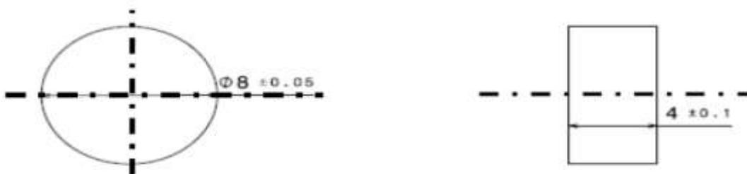
Figure VI.6 : Géométrie de l'éprouvette de compression.
