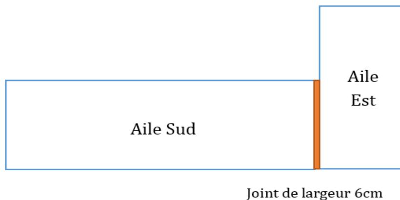
Figure 48 : La disposition du joint
