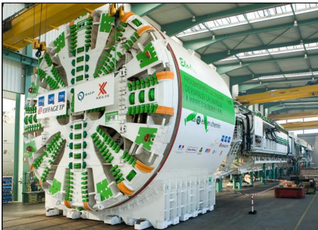
Figure III.6 : Machine à attaque globale (Creusement mécanique en terrains rocheux) [S3]
