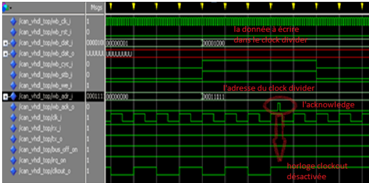
Figure 3.8: Simulation de l'étape d'écriture dans un registre du contrôleur
