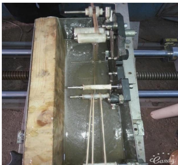
Figure 4.4 : Fibres passant dans le bain de résine [7].
