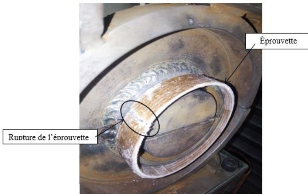
Figure 4. 11 : Dispositif de test “Split disk” et éprouvette
