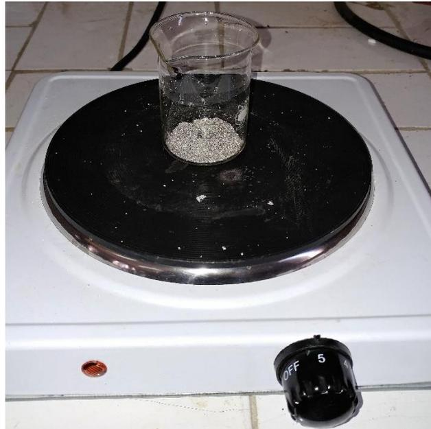
*Figure 5.4. Séchage de la poudre décapé à l'aide de la plaque chauffante.*
