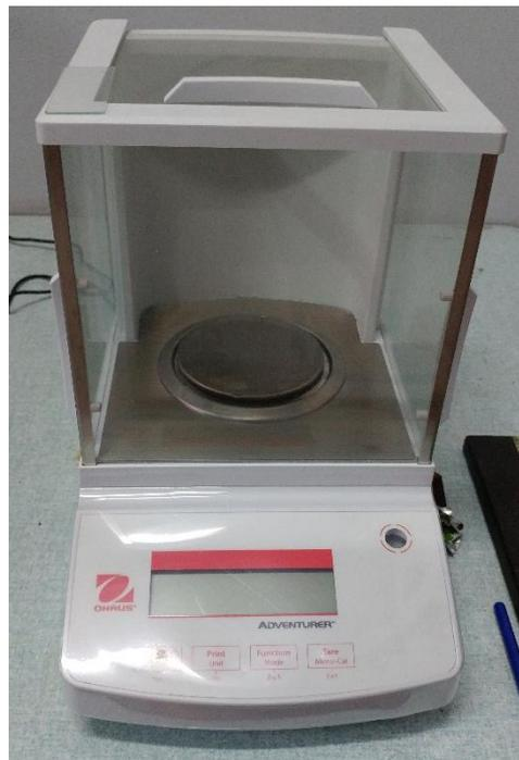
*Figure 5.6. Balance électrique.*
