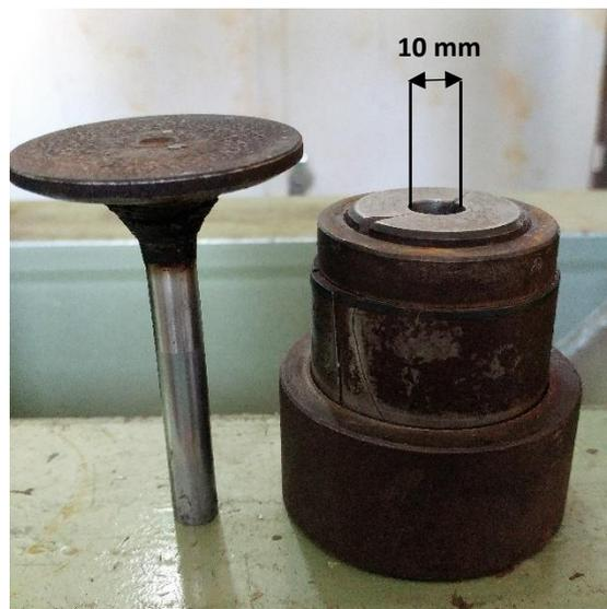
*Figure 5.8. La matrice de compactage utilisée*
