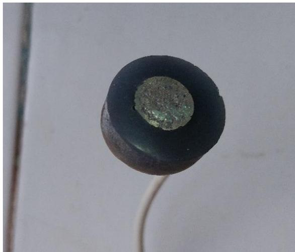
*Figure 5.10. Échantillon enrobé à froid dans de la résine.*
