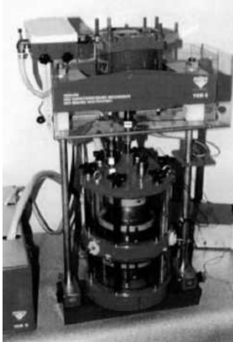
FIGURE 1.10 – Appareillage du tri-axial à charges répétées
