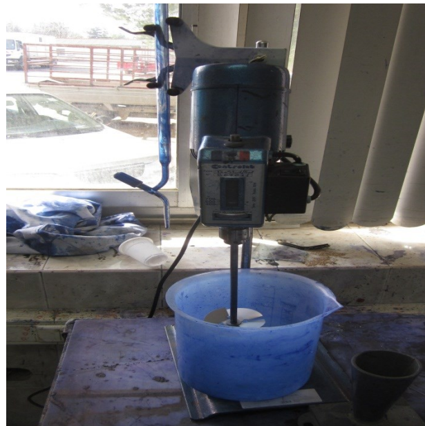
Figure.IV.11. Appareil de l'essai de bleu de méthylène
