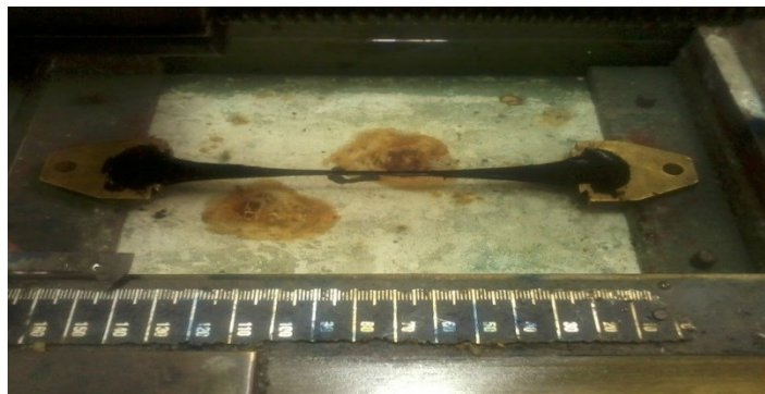
Figure.IV.16. Essai de ductilité
