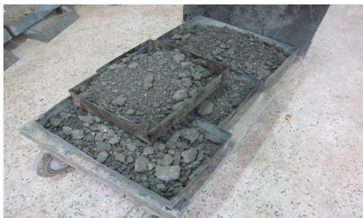
Figure.IV.17. Echantillon du fraisât
