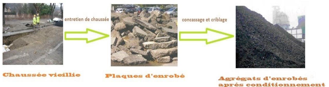
Figure.II.1. Origine des agrégats d'enrobé
