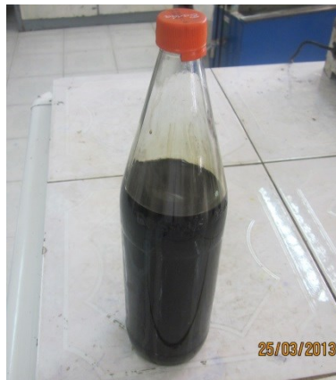
Figure.IV.22. Mélange (bitume + diluant)
