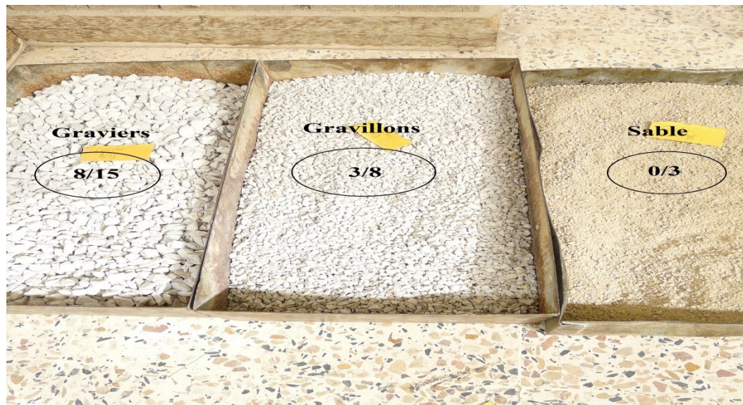
Figure.IV.2. Les différentes fractions de granulats
