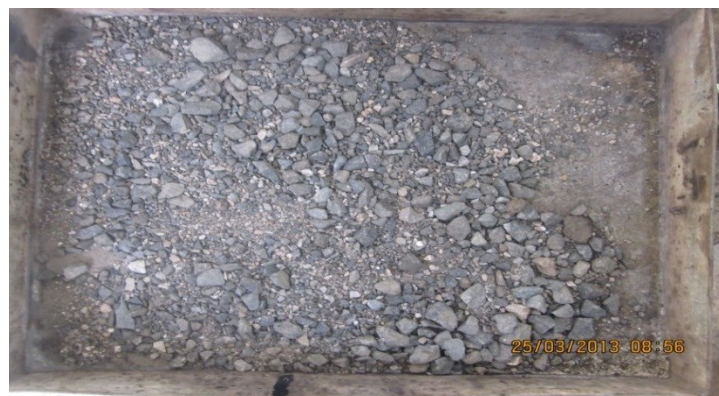
Figure.IV.20. Fraisât après désenrobage
