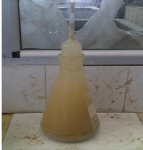
Figure.IV.3. Essai de la masse volumique
