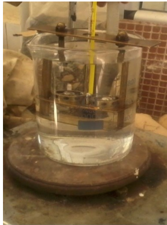
Figure.IV.14. Appareil de l'essai Bille-Anneau
