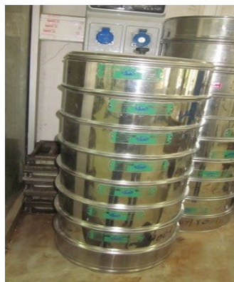
Figure.IV.7. Série de tamis (0,08-16mm)
