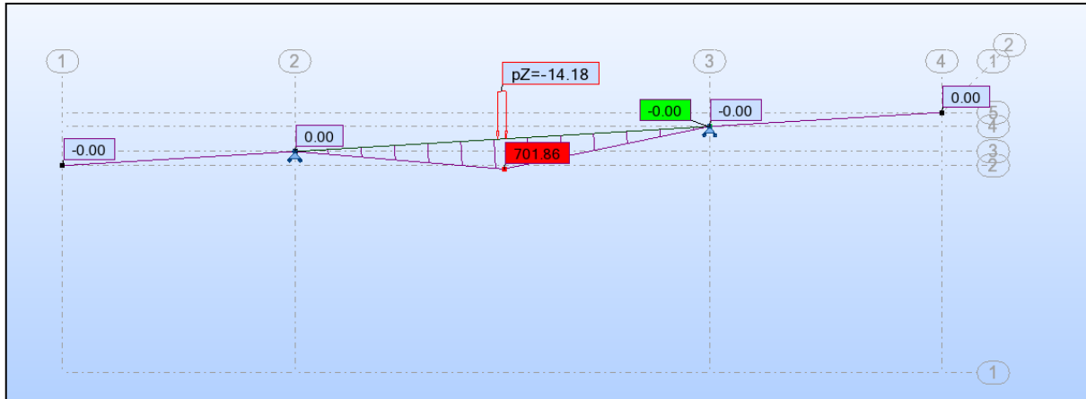
Figure 5.4 : Diagramme du moment fléchissant dû au clavage de rive.
