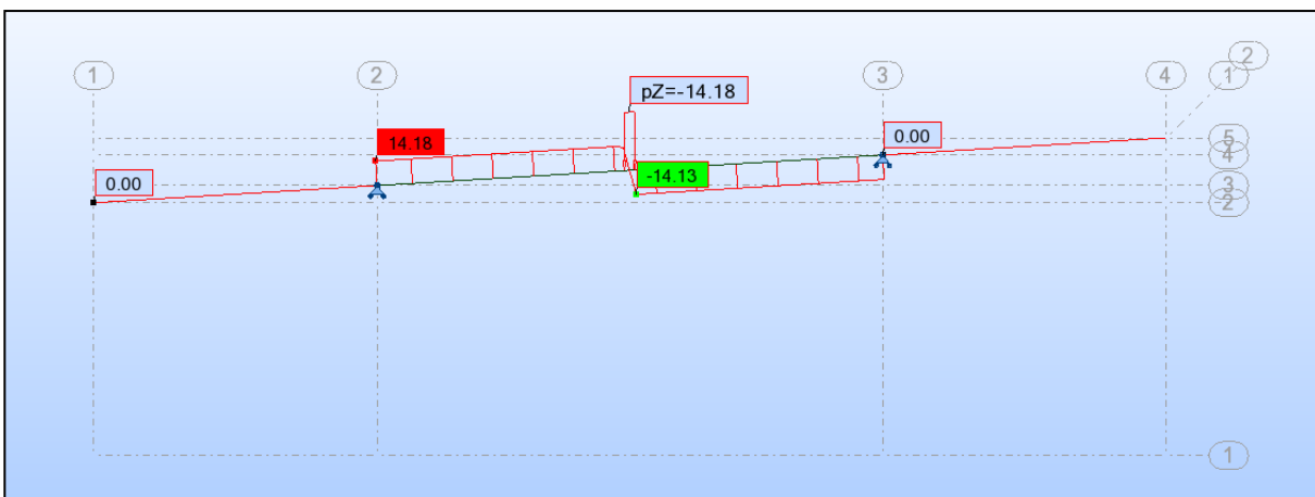
Figure 5.5 : Diagramme de l'effort tranchant dû au clavage de rive.
