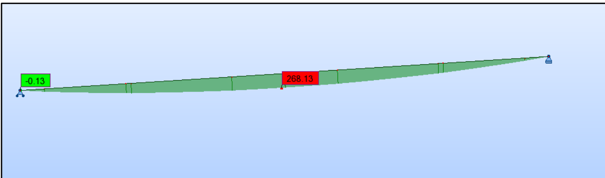
Diagramme du moment fléchissant en T.m sous l'effet de la combinaison ELU BC 2v.
