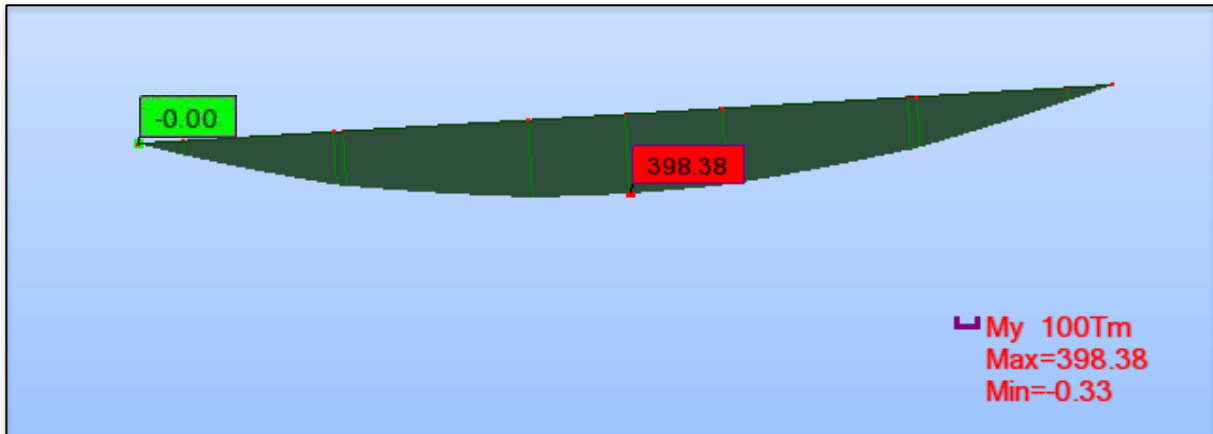
Figure 5.16 : Diagramme du moment fléchissant en t.m sous l'effet de la combinaison D240.
