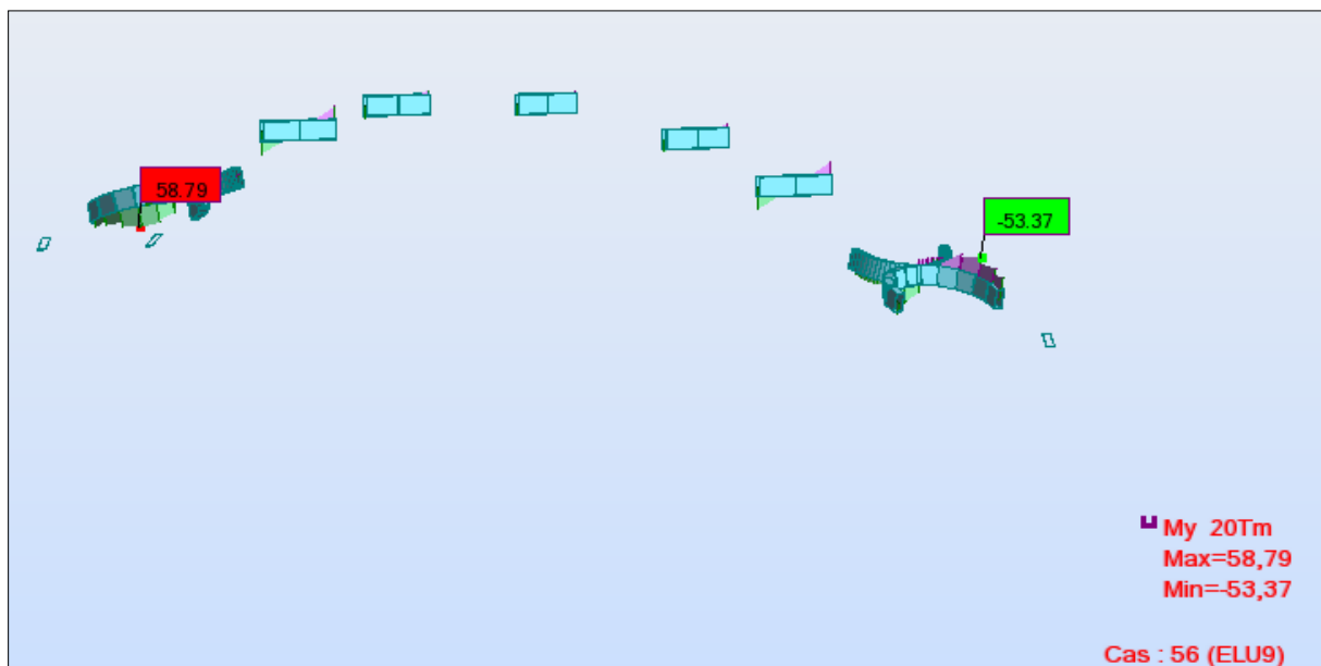
Figure V. 21 Moment de flexion des entretoises sous la combinaison ELU9.
