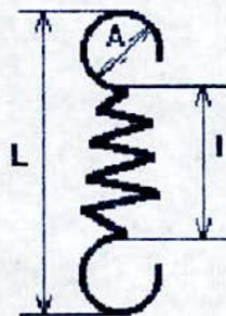
La longueur nécessaire au montage  $L = l + 2 A$
