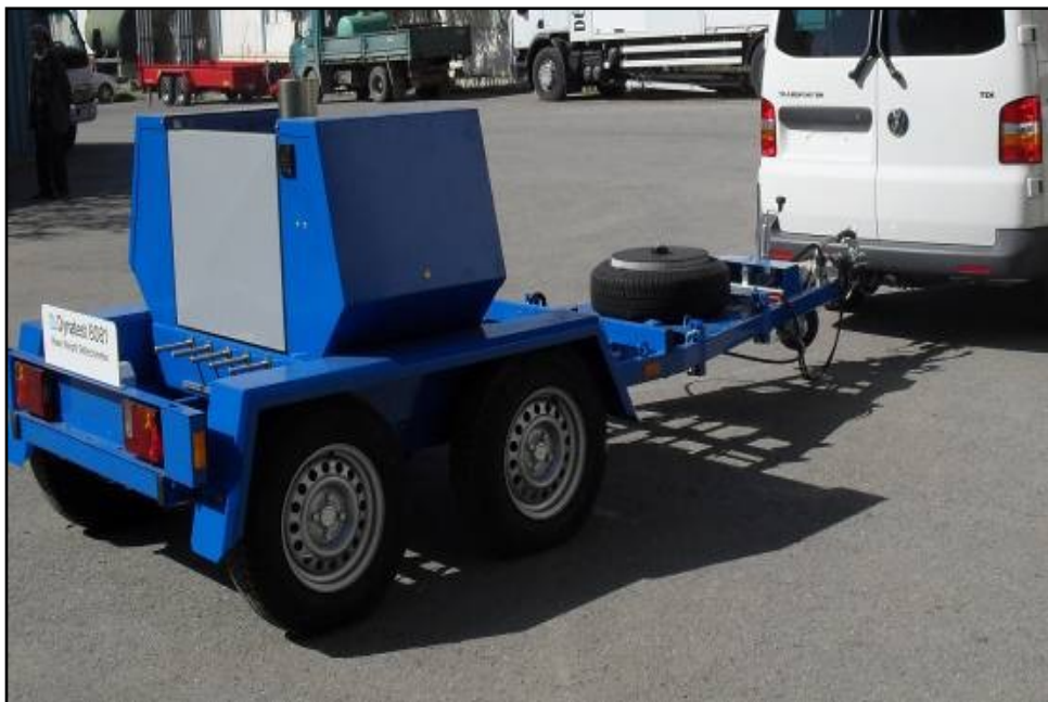
Figure II. 3 : L'appareil d'acquisition HWD du CTTTP [3]
