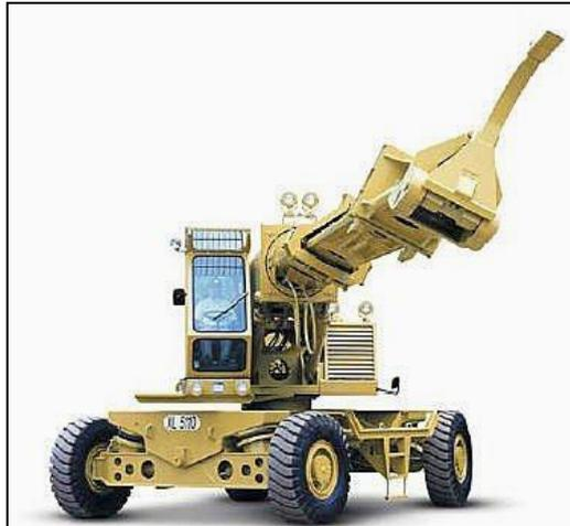
*Machine à effectuer les purges en tunnel*
