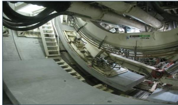
Figure II.10 : Tunnelier avec bouclier à front ouvert.
