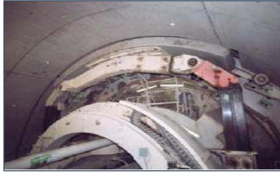
Figure II.11 : Tunnelier avec bouclier à front confiné.
