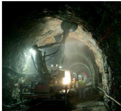
*machine d'attaque ponctuelle utilisant un disque de coupe monté à l'extrémité d'un bras articulé*
