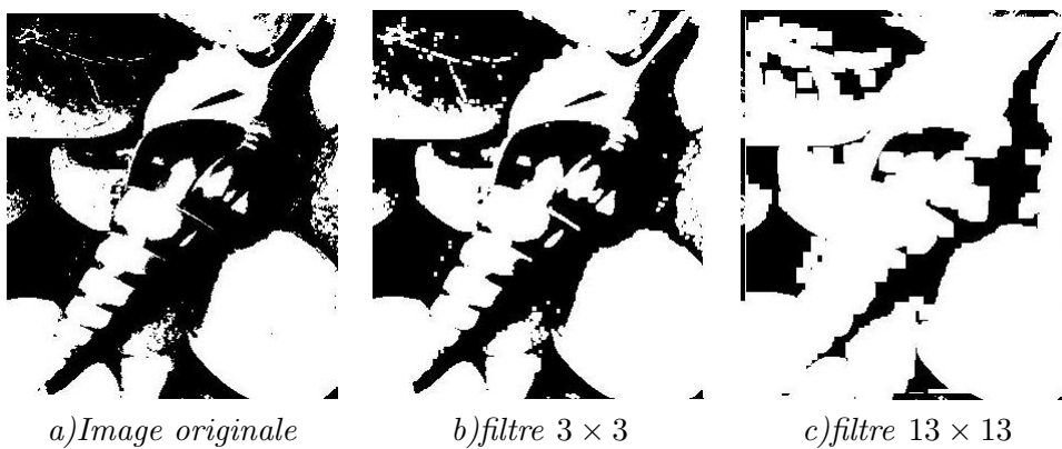
FIG. 1.11 – Le filtrage par dilatation
