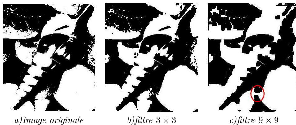
FIG. 1.13 – Le filtrage par fermeture
