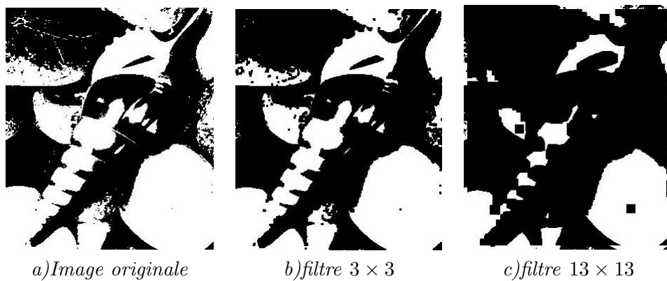
FIG. 1.10 – Le filtrage par érosion
