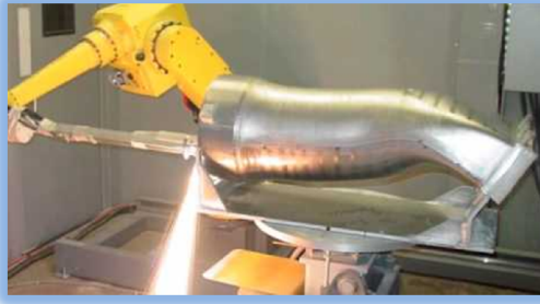
Figure 1.8 : Principe de la Projection par Plasma a l'Air -APS- [15].
