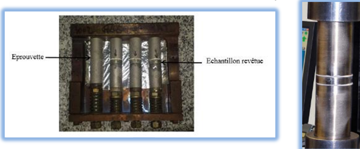
Figure 3.12: Assemblage d'une éprouvette pour l'essai de traction selon l'ASTMC633
