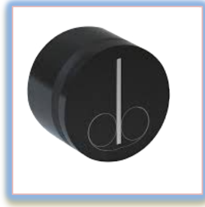
Figure 3.3: Echantillon enrobé à chaud
