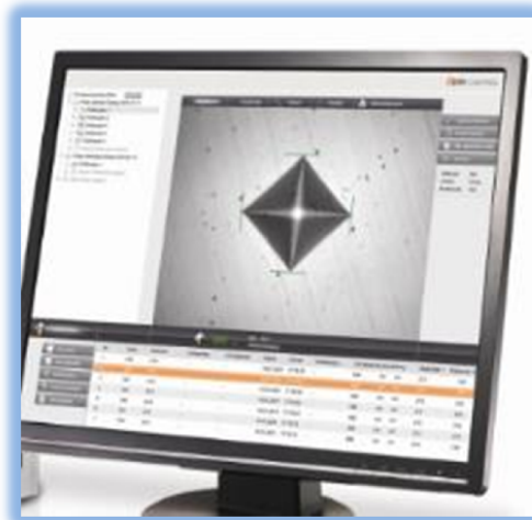
Figure 3.7 : Schéma de l'empreinte de pénétrateur dans l'essai de micro dureté Vickers
