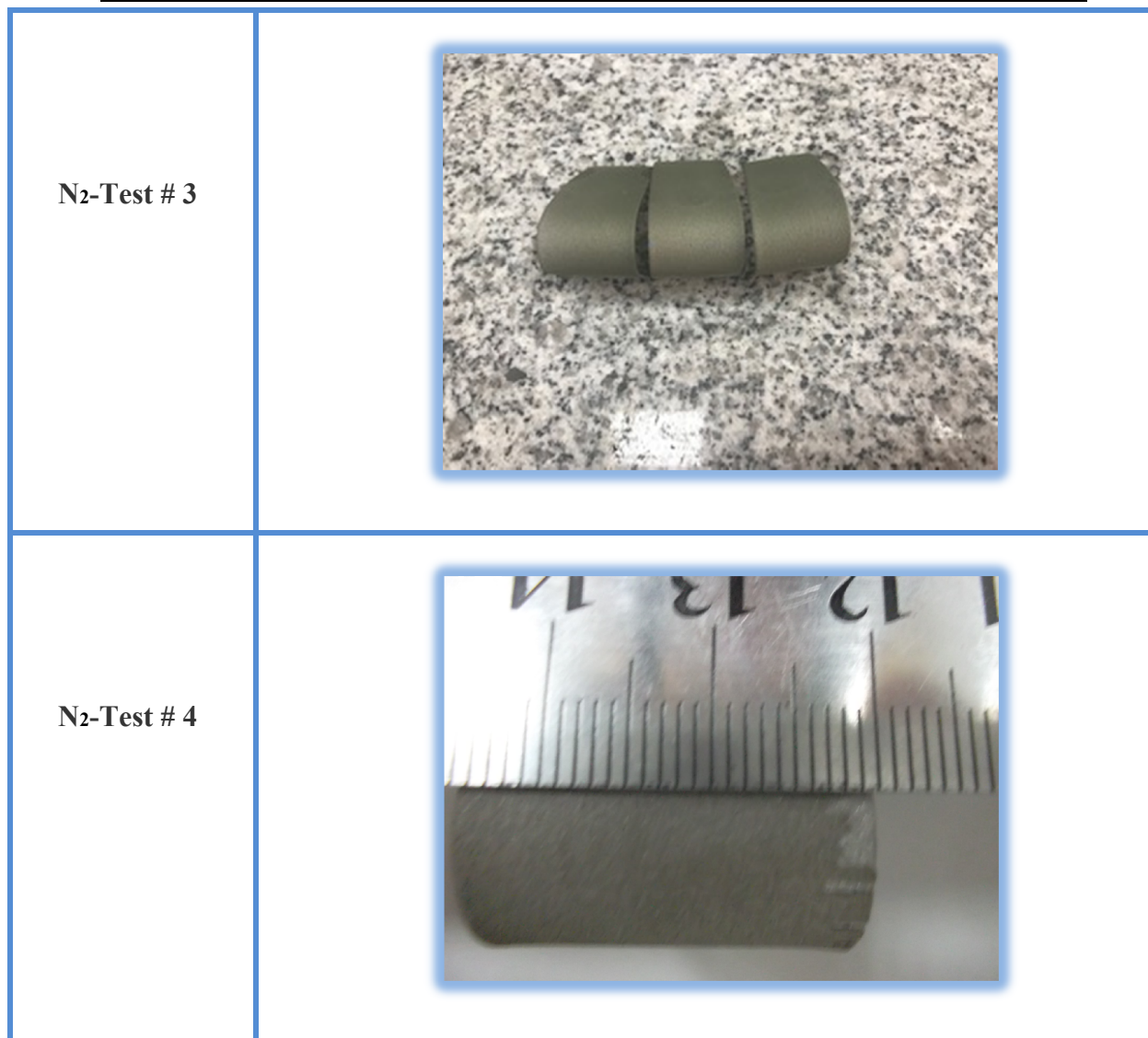
Figure 4.7 : Mesure de l'écaillage après test de pliage
