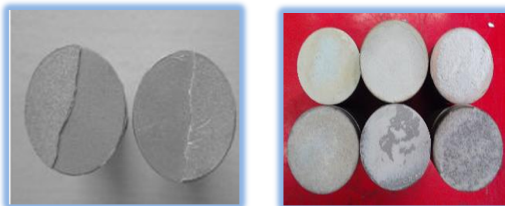
Figure 3.13 : Représentation schématique d'un revêtement après essai de traction
