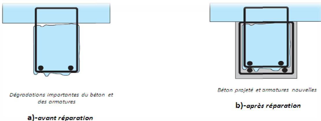
Figure 2-6 Réparation des poutres par béton projeté [3]
