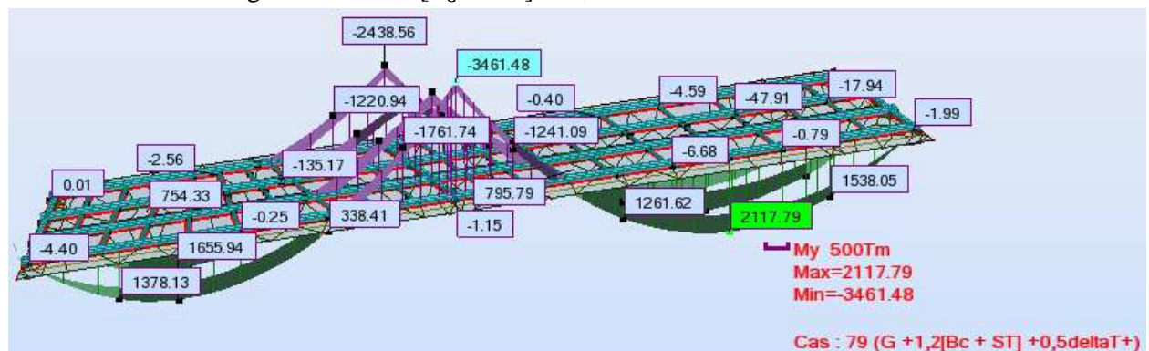
Fig.VI.17. Diagramme du moment à l'ELS sous la combinaison de charge 11.
