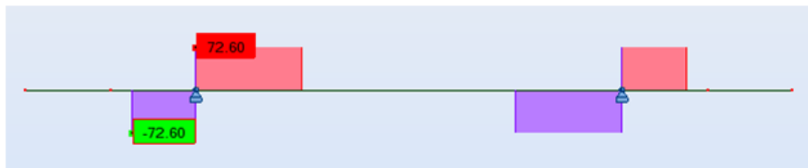
Figure. V.10. Diagramme de l'effort tranchant sous B c
