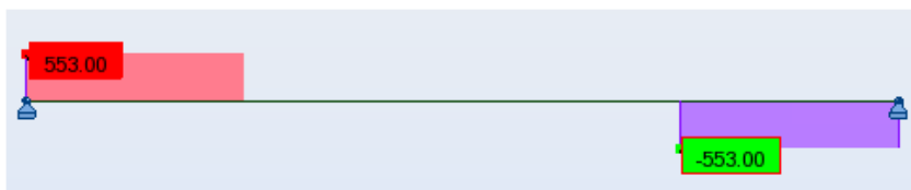
Figure. V.32. Diagramme de l'effort tranchant pour l'entretoise
