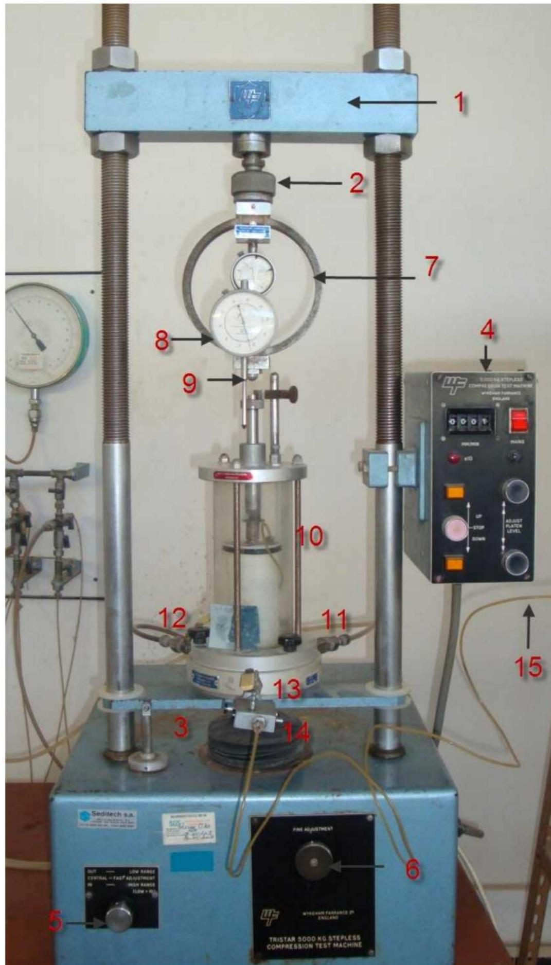
**Figure III.12 :** Dispositif du chargement axial.
