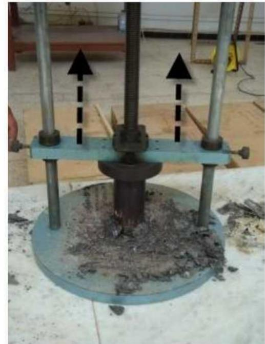
**Figure IV.6 :** Fin du taillage de l'éprouvette
