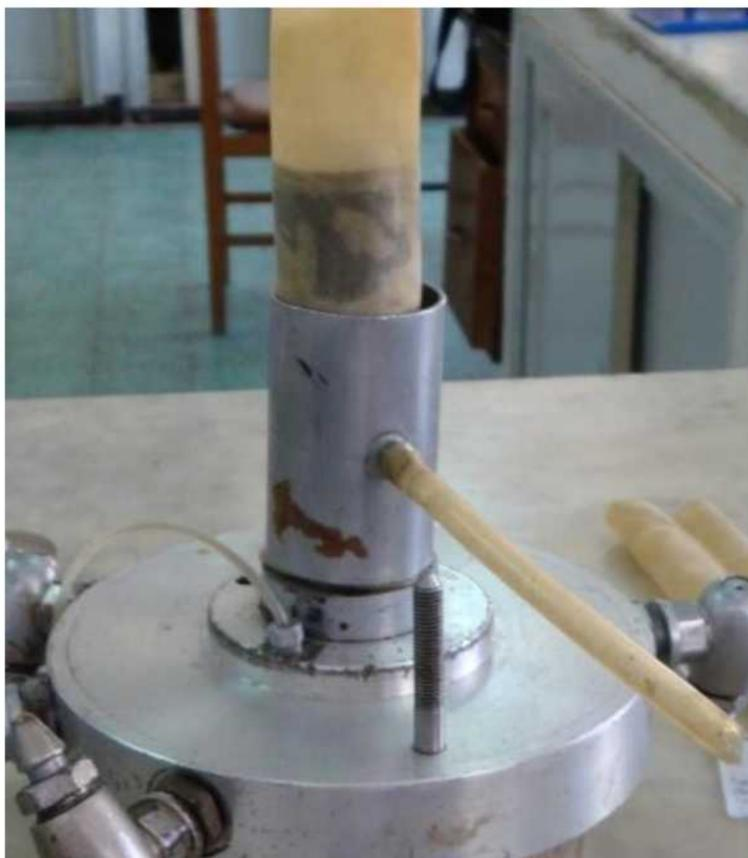
**Figure IV.13 :** Utilisation du tendeur de membranes
