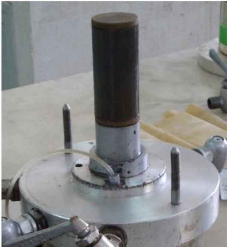
**Figure IV.11 :** Installation de l'éprouvette
