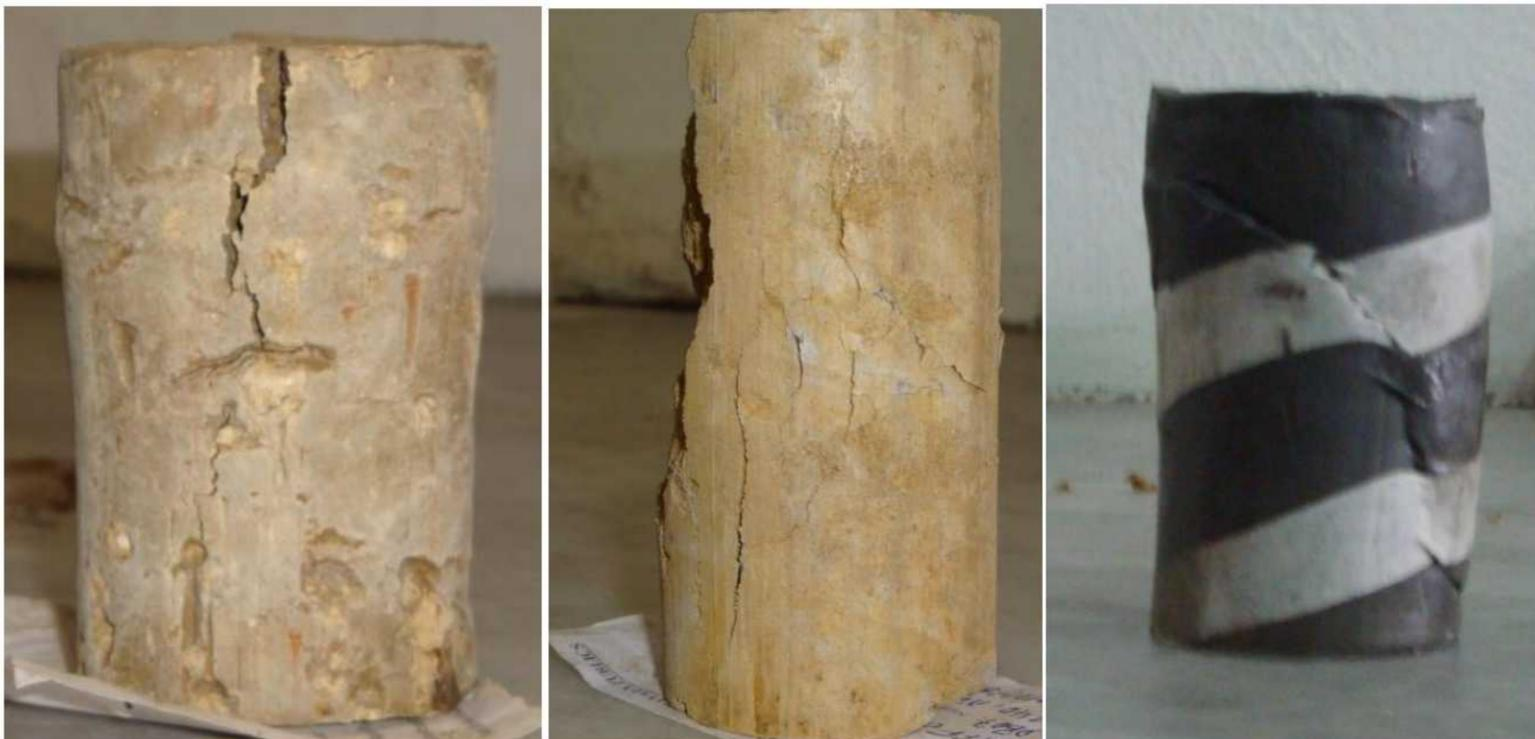
**Figure IV.19:** Types des ruptures des éprouvettes.
