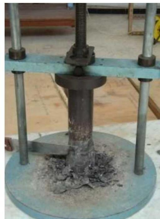
**Figure IV.4 :** Taillage de l'échantillon
