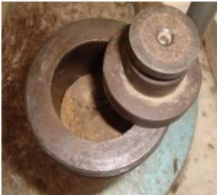
**Figure IV.7 :** Préparation à l'extraction de l'éprouvette
