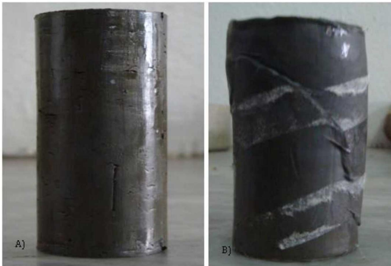
**Figure IV.22** : Etat de l'éprouvette avant et après cisaillement.
