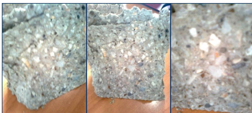
Figures 6.18 : Illustration macroscopique du BAP dosé fillers UF5.
