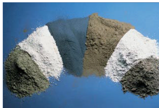
Figure 1.2 : Ajouts cimentaires (de gauche à droite) : cendres volantes (classe C), métakaolin (argile calcinée), fumée de silice, cendres volantes (classe F), laitier et schiste calciné.
