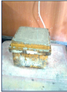
Figure 5.12: Mesure de la masse volumique
