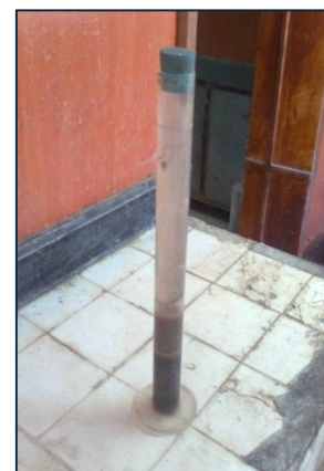
Figure 5.6 : Essai d'équivalent de sable
