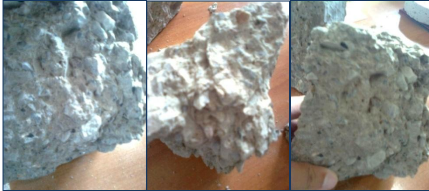
Figures 6.20 : Illustration macroscopique du BAP dosé 10,15 et 20 % de fillers F50.
