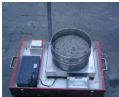
Figure 2.7 : Essai de stabilité au tamis [25]
