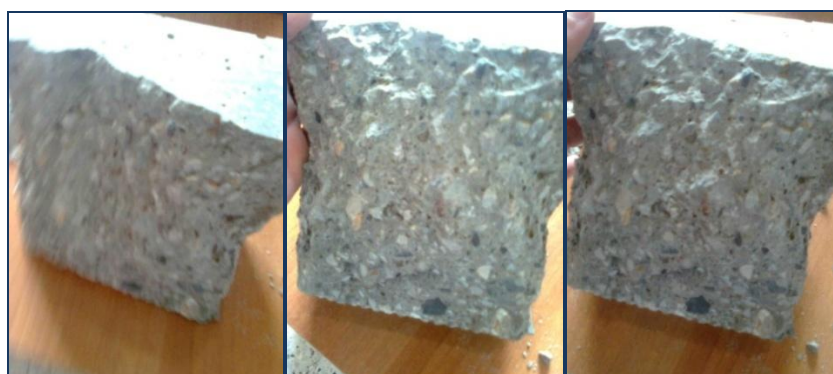
Figures 6.19 : Illustration macroscopique du BAP dosé 5% de fillers UF5.
