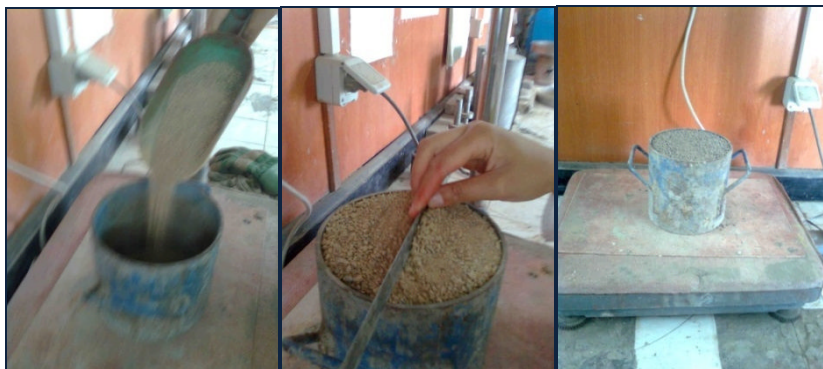
Figure 5.7 : l'essai de la masse volumique apparente (les trois étapes)
