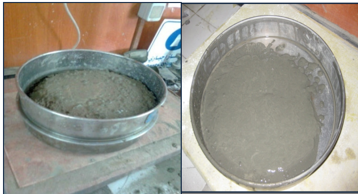
Figure 5.11: Essai stabilité au tamis.
