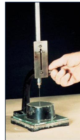
Figure 5.3 : Essai de consistance (Appareil de Vicat).
