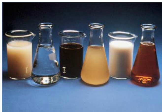
Figure 1.3 : Adjuvants liquides (de gauche à droite) : agent anti-lessivage, réducteur de retrait, réducteur d'eau, agent moussant, inhibiteur de corrosion et agent entraîneur
