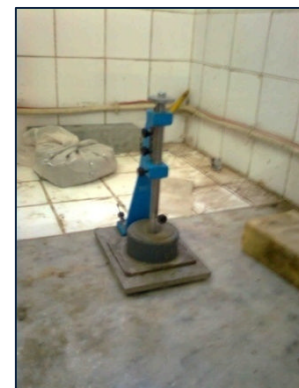
Figure 5.4 : Essai de Prise (Appareil de Vicat)
