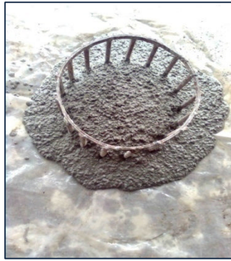
Figure 5.10: Essai d'étalement modifié
