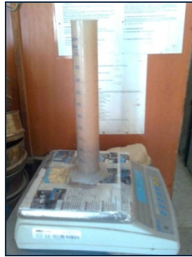
Figure 5.8 : l'essai de la masse volumique absolu
