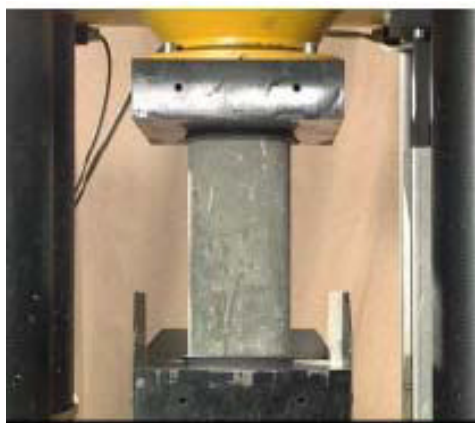
Figure 2.9 : Résistance mécanique en compression de BAP. [27]
