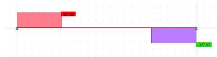
Fig.VI.27.Diagramme de l'effort tranchant.
