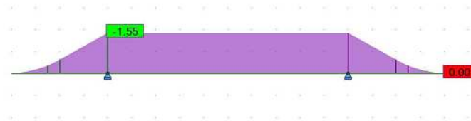
Fig.VI.6. diagramme de moment des charges CCP.
