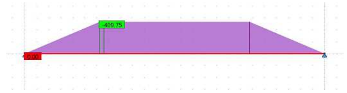
Fig.VI.26.Diagramme du moment fléchissant
