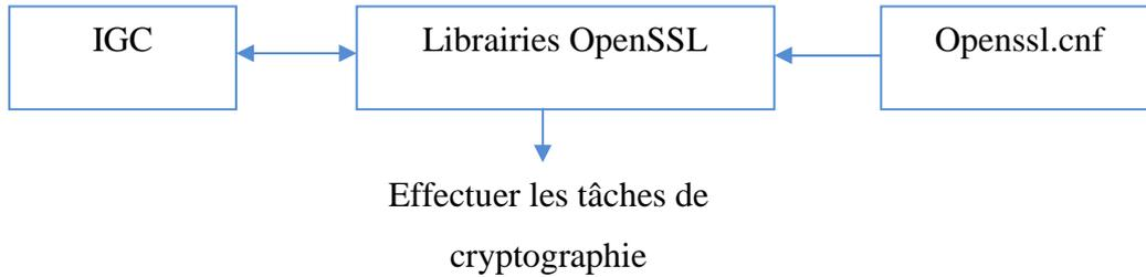
**Figure II.6** Architecture d'OpenSSL.
