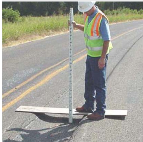
Figure 1.3 : Exemple de chaussée atteinte d'orniérage (Bahssem, 2006)
