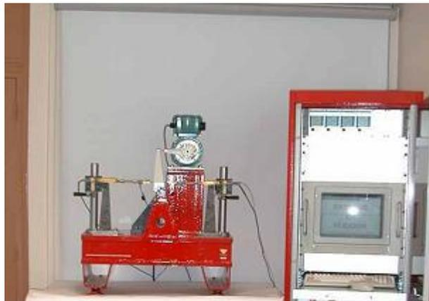
Figure (II-11) : Essai de fatigue en flexion 2 points sur éprouvettes trapézoïdales [3]
