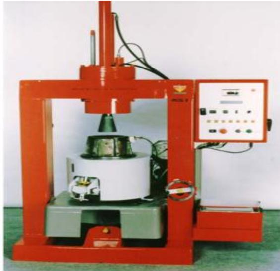
Figure (II-1): Presse à cisaillement giratoire [3]
