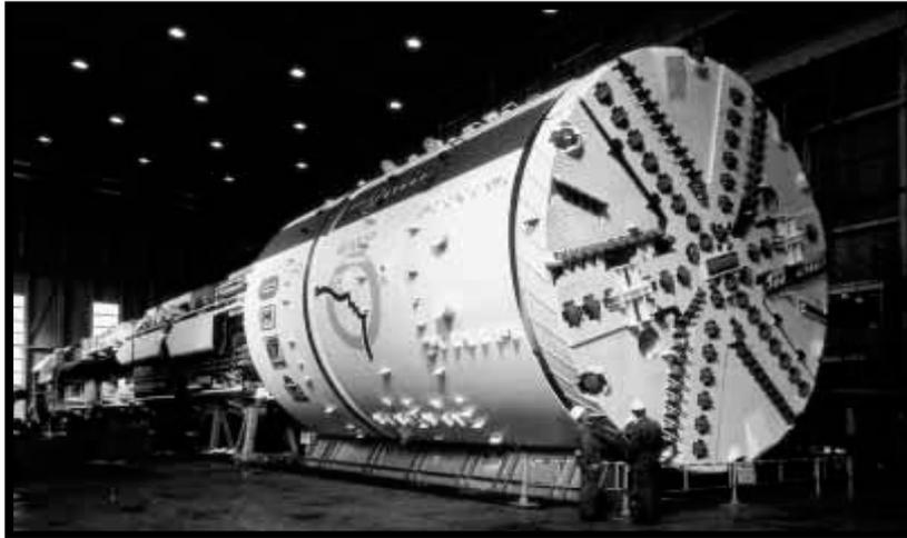
**Figure3-4** Bouclier à pression de boue
