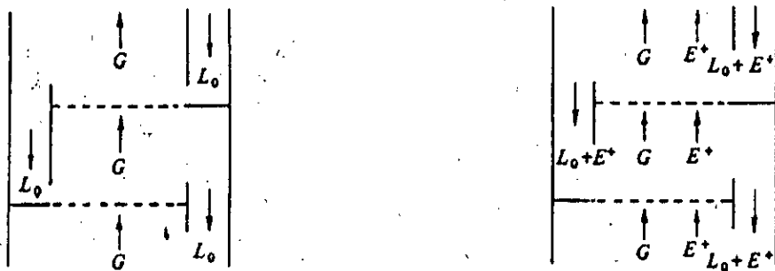
Fig .5.1 a) Ecoulement sans entrainement b) Ecoulement avec entrainement
