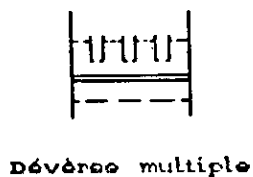
Fig. 1.3 Quelques modes d'écoulement utilisés dans les colonnes à plateaux
