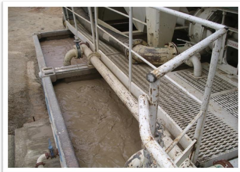
**Figure III. 3 :** Boue bentonitique (photo reproduite avec la permission de Metro d'Alger)
