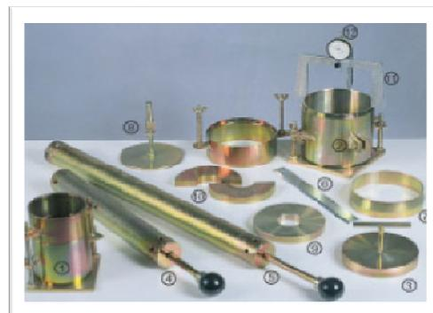
Image4.5 matériel d'essais de Proctor et CBR
