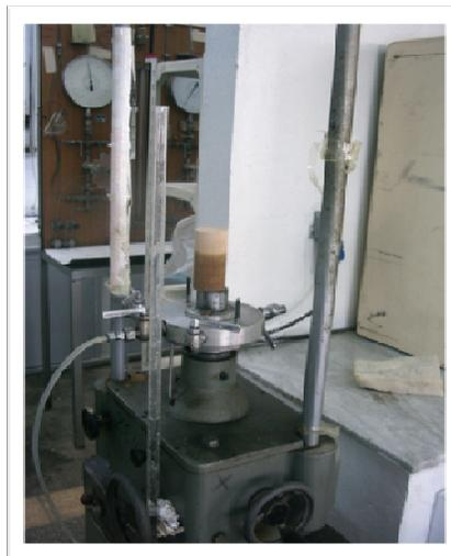
**Image 4.19** éprouvette du sol naturel en cours d'essai de remontées capillaires
