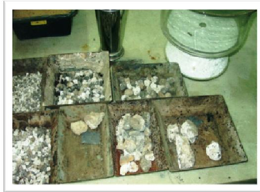
**Image 4.2** Séparation des grains de l'échantillon N1 par voie humide
