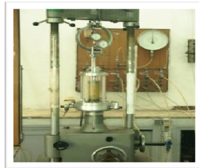
**Image4.8** Le matériel de l'essai de compression simple (la cellule et la presse de triaxial, le moule de confection des éprouvettes)
