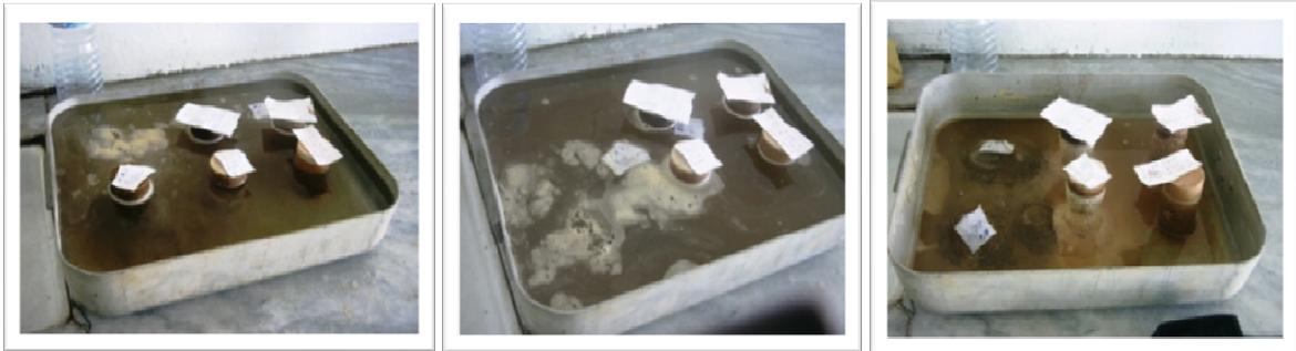
**Image 4.20** l'effet du  $\text{CaCO}_3$  sur la tenue à l'eau des échantillons stabilisés au lignosulfonate
