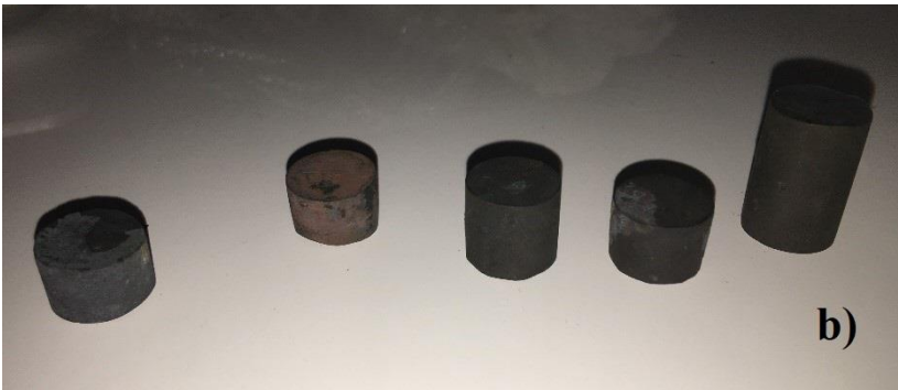
Figure 3.3 : a) Echantillons avant trempe, b) Echantillons après trempe.
