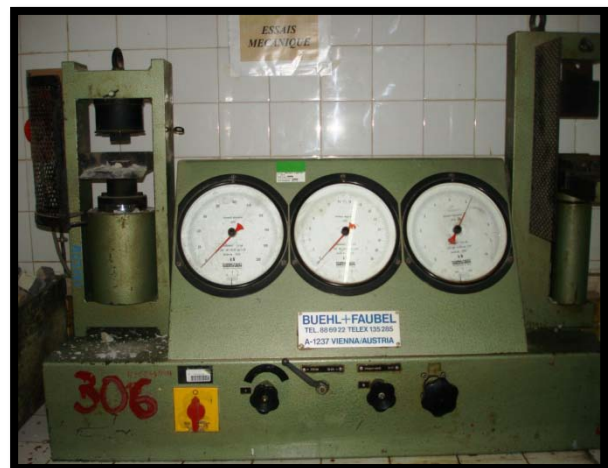
Fig. 9 : Machine pour essais mécaniques (compression)
