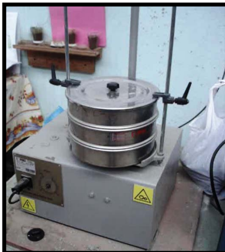
Fig. 2 : Tamiseuse (capacité 50 gr de fibres/h)
