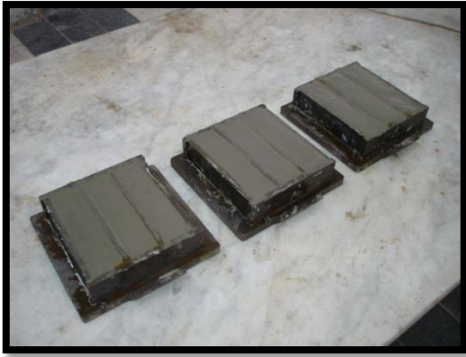
Fig. 4 : Moules prismatiques 4x4x16 cm 3
