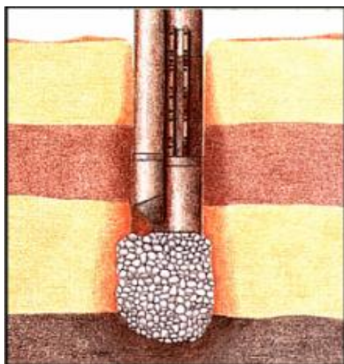
Figure 7-11 Fonçage au vibreur
