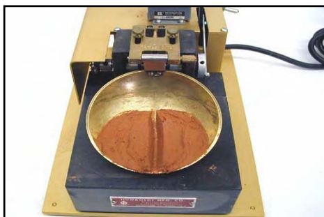
Figure I-11 : essai de détermination de la limite de liquidité
