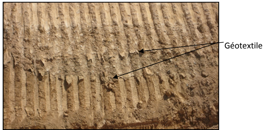
Figure II-2 : le géotextile dans le sol.
