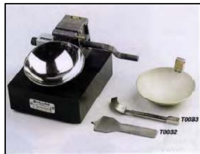
Figure I-11 : essai de détermination de la limite de liquidité
