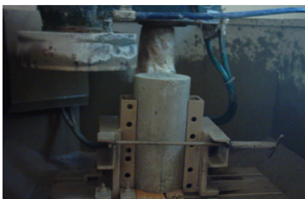
Photo 3.1 : Surfaçage mécanique des éprouvettes de contrôle
