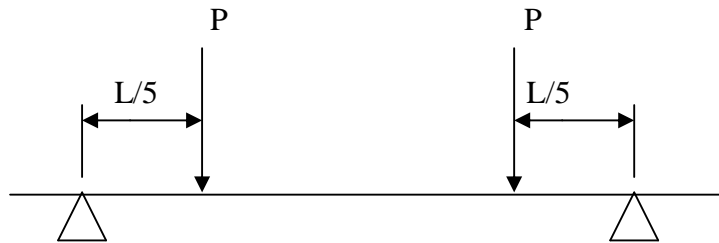
Figure 3.1b : Effort tranchant « cisaillement-compression »
