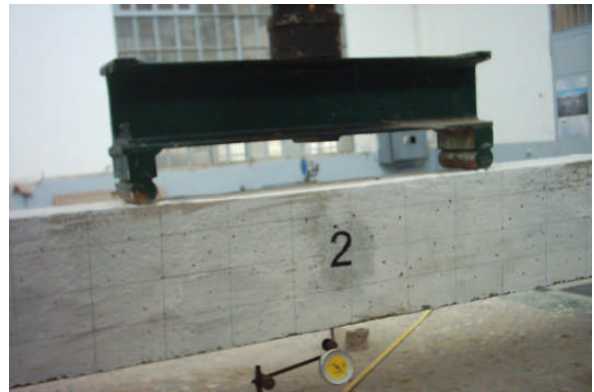
Figure 8 : Poutres témoins en cour du chargement
