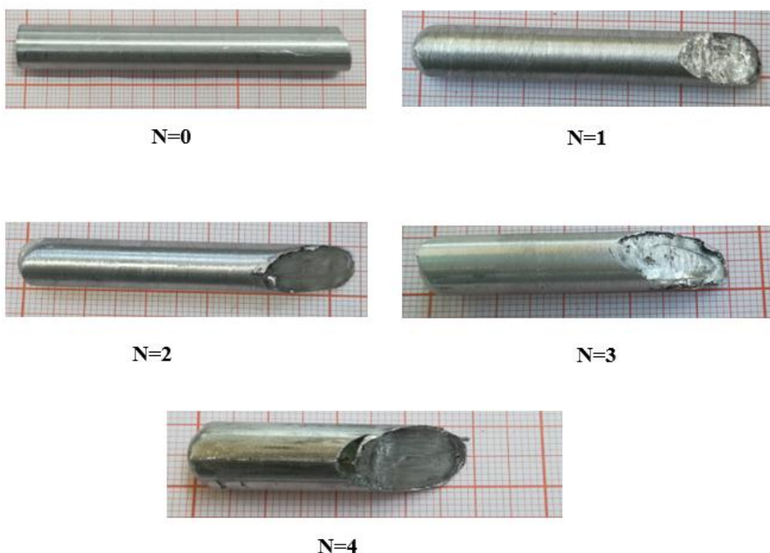
Figure 5-1- Présentation des billettes de l'alliage Al-Mg-Si 6063 déformées par ECAP.
