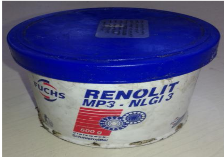
Figure 4-9- La graisse de lubrification à base de lithium.
