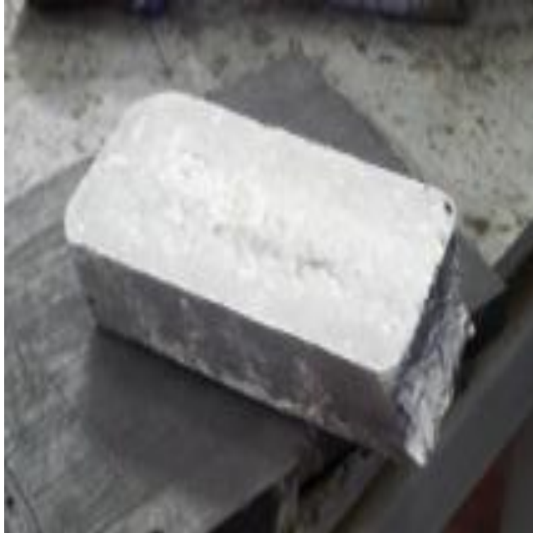
Figure 4-1 -Lingot de l'alliage étudié après élaboration.
