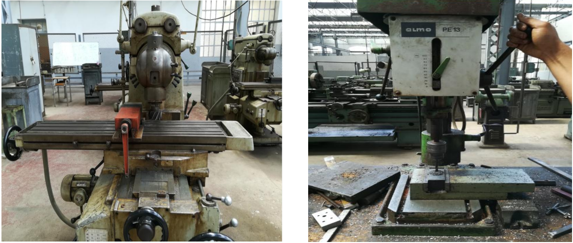
Figure 4-6-Machine de fraisage et perçage de la pièce renfort.
