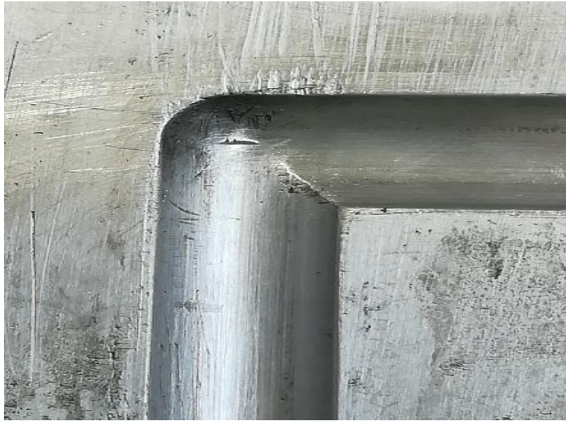
Figure 4-19- L'endommagement de l'angle de canal.
