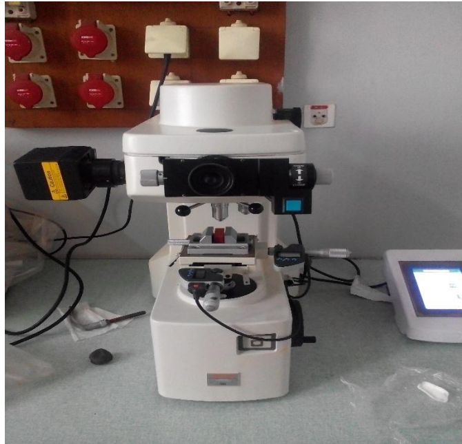
Figure 3.18 : Machine de micro dureté utilisée.
