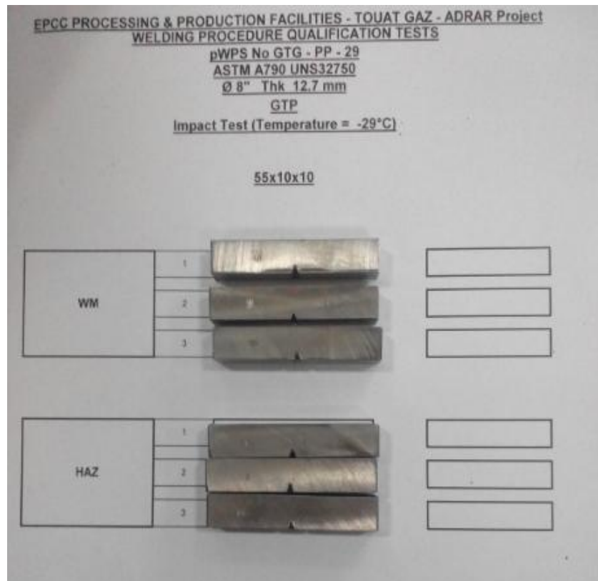
Figure 3.13 : Eprouvettes de résilience utilisées.
