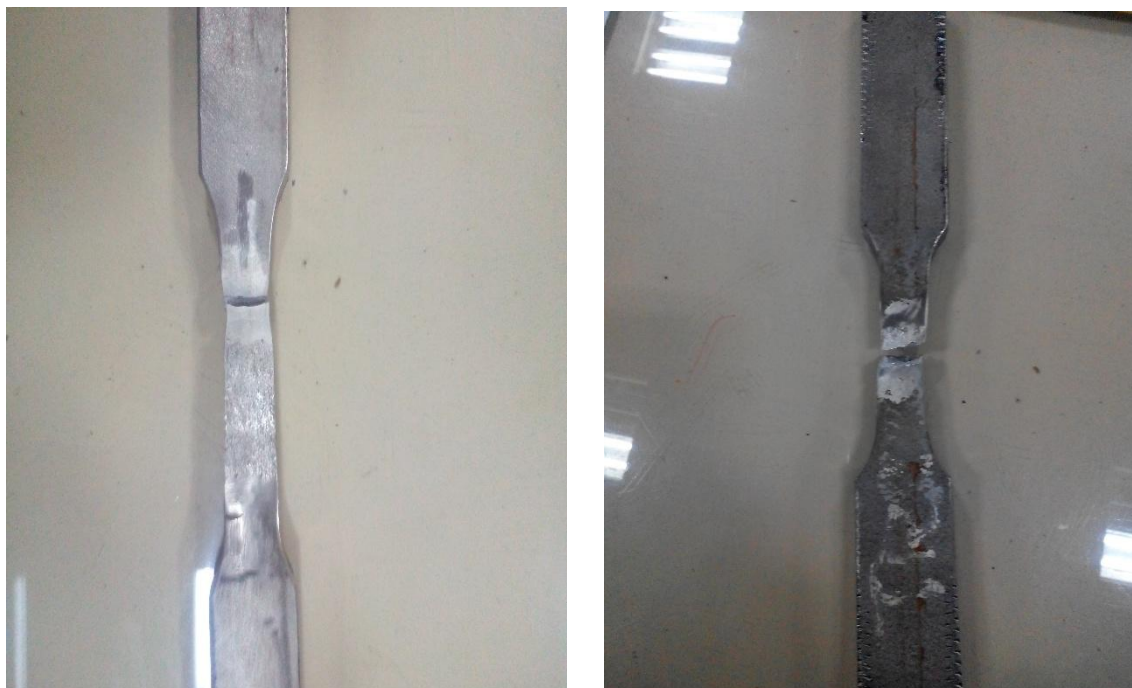
Figure 4.17: Eprouvettes de traction après la rupture.
