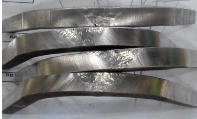
Figure 4.19: Eprouvettes après l'essai de pliage.
