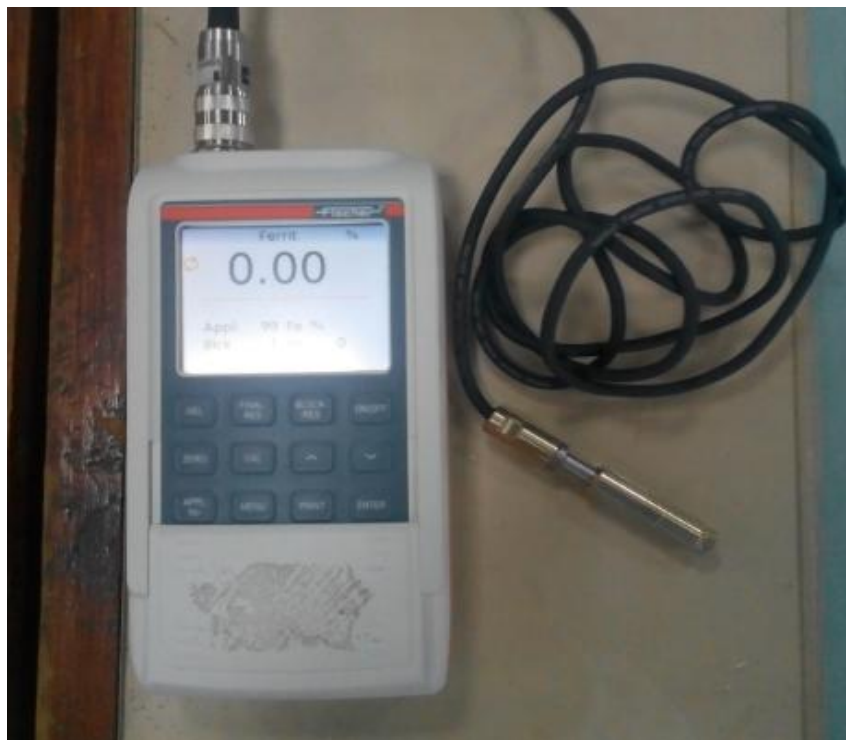
Figure 3.5 : Ferritoscope utilisé pour l'estimation du taux de ferrite.
