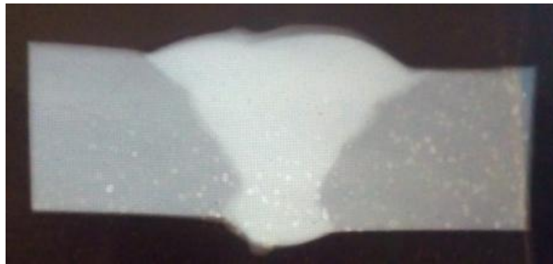
Figure 4.3: Macrographie du profil du joint soudé.
