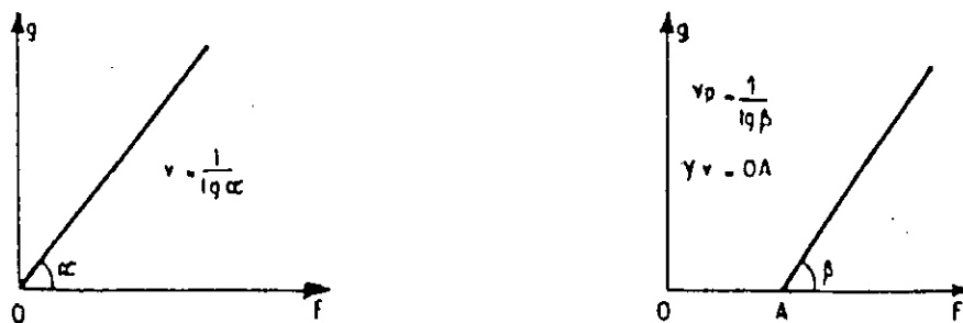
Fig. 2.2 : Modèles de Newton et de Bingham (d'après Poupeloz)
