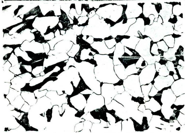
fig.I.2: Les trois zones de la couche cimentée (x1200)
