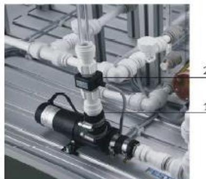
**Figure I-5 capteur de débit.**
